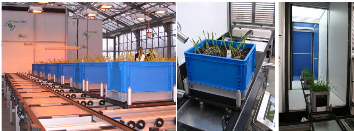
Abb. 1: Die 'Moving fields' Anlage ermöglicht es, Pflanzenbestände durch ein Gewächshaus fahren zu lassen. Pflege (Bewässerung, Wiegung, Düngung) und Beobachtung (Fotografieren) können dadurch vollautomatisch und äußerst exakt geschehen.
