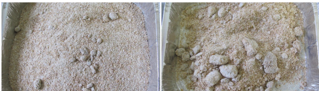
Verklumpungen im Futter nach Einmischen von 3 % bzw. 10 % Inulin – Abhilfe durch Diamol
