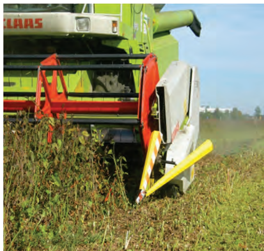
Abb. 5: Um die Hülsen ganz unten zu erwischen, muss das Schneidwerk tief eingestellt werden
