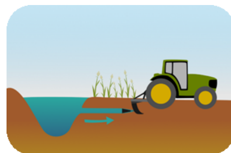
Abbildung 2: Ziehen von Hohlgängen
