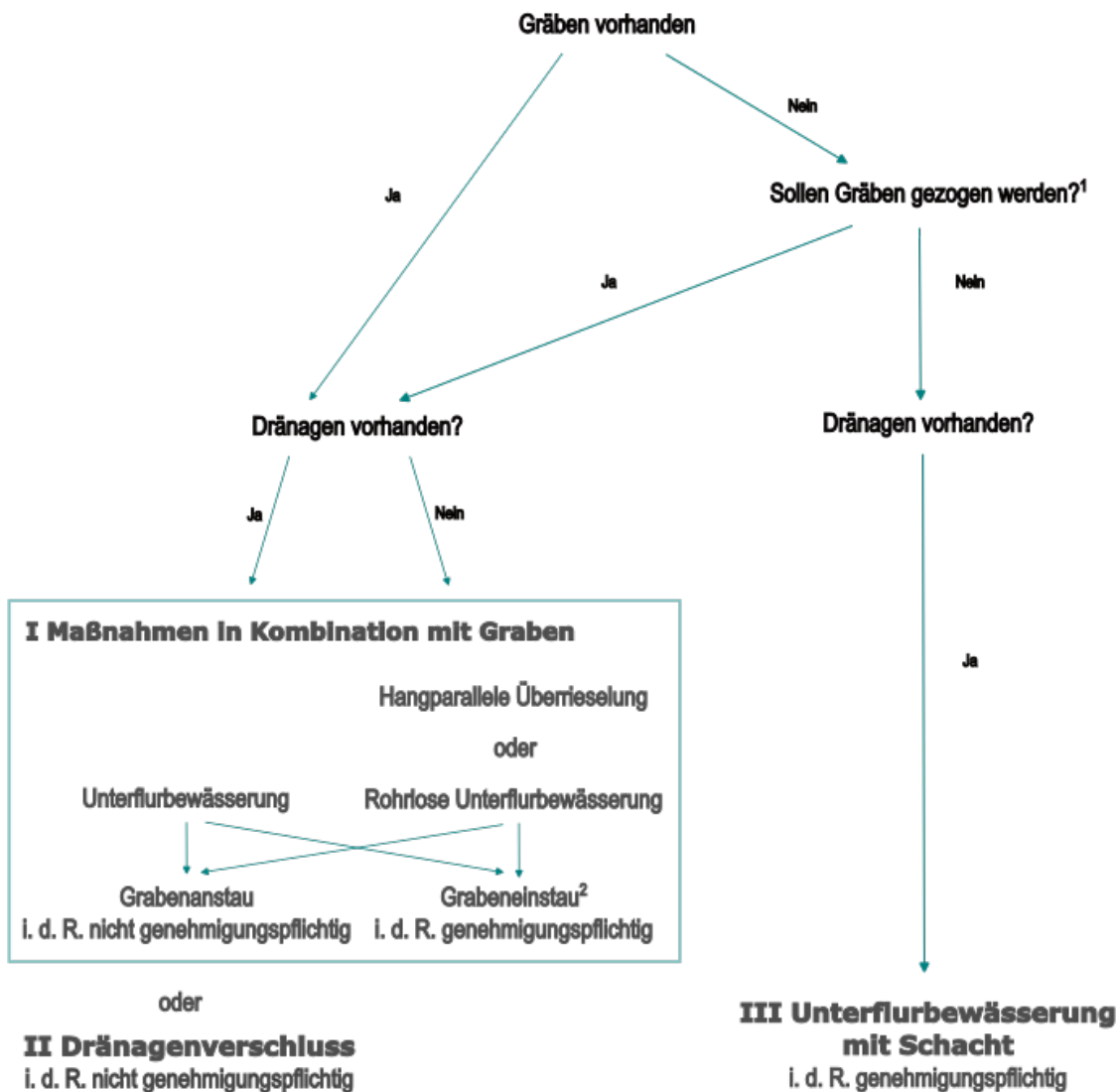
Abbildung 1: Entscheidungsbaum für die Umsetzung von Maßnahmen zur Wasserstandsanhhebung in Gewässern von wasserwirtschaftlich untergeordneter Bedeutung . Die Genehmigungspflichtigkeit muss im Einzelfall geprüft werden. Die Grafik bietet lediglich eine unverbindliche Orientierung.
