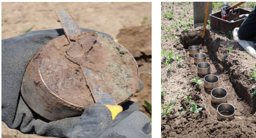
Abb. 2: Stechzylinderprobenahme im Acker: links: Stechzylinder mit Bodenkern, rechts: Verteilung von Stechzylindern in einer Aufgrabung von etwa 10 cm Tiefe für die Probenahme in der Krume vor dem Einschlagen
