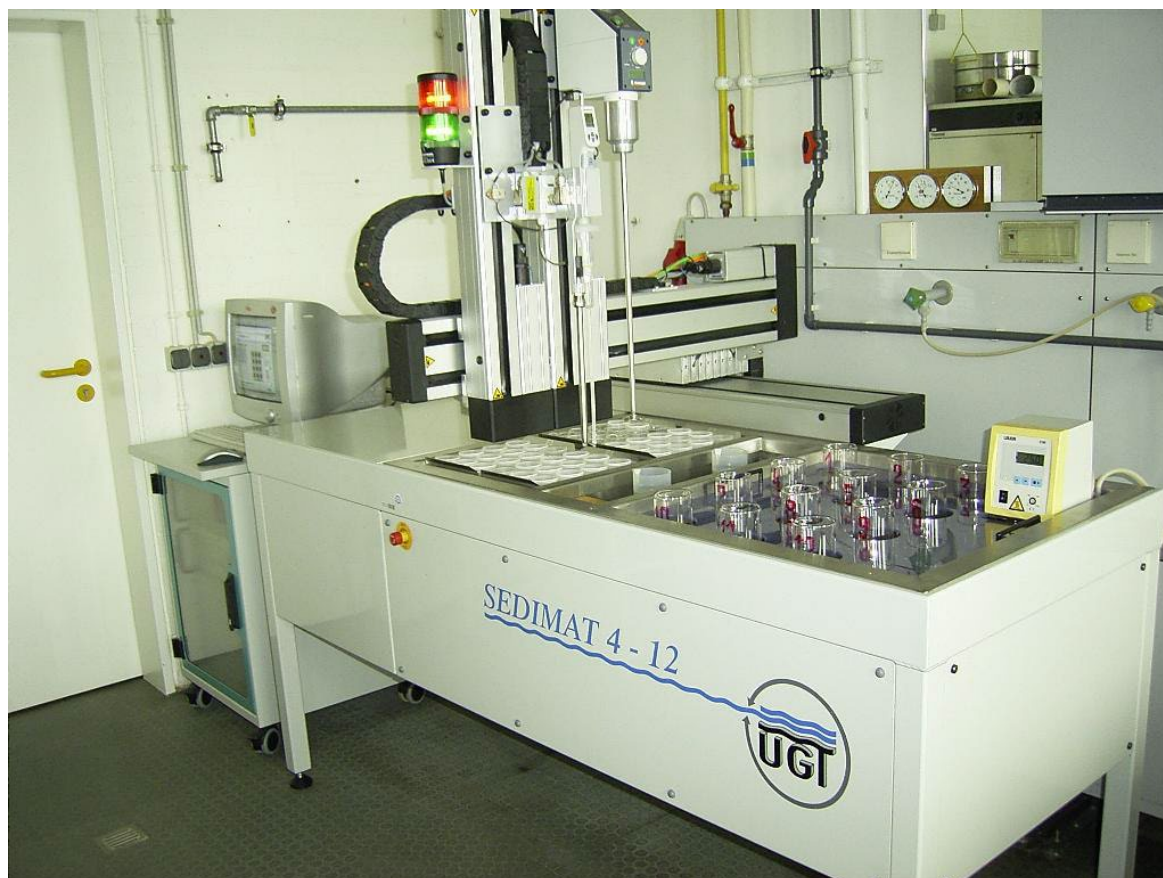
Abb. 1: Laborautomat SEDIMAT 4-12 zur Bestimmung der Korngrößenfraktionen der mineralischen Bodensubstanz kleiner 0,063 mm
