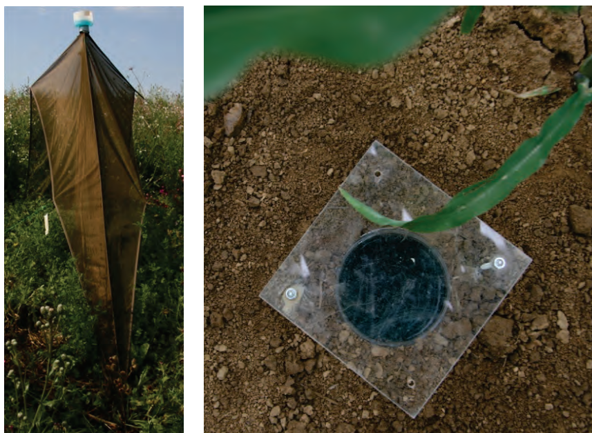
Abb. 18: LINKS: bioform Malaisefalle nach Prof. Bartak in oliver Ausführung. Insgesamt wurden 39 Fallen (3 pro Standort), installiert. Die Fangdose zeigte nach Süden. RECHTS: Bodenfalle mit Abdeckung aus Plexiglas 5 cm über der Oberfläche. Fangflüssigkeit war jeweils ein Glykol-Wassergemisch im Verhältnis von 1:3 mit einem Schuss Spülmittel.
