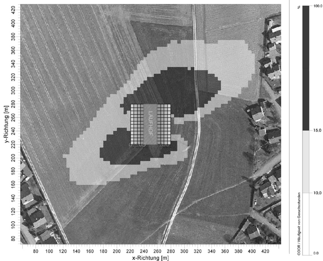
Abb. 6: Immissionsverhalten eines Laufhofes bei zweiseitiger Gebäudeanordnung
