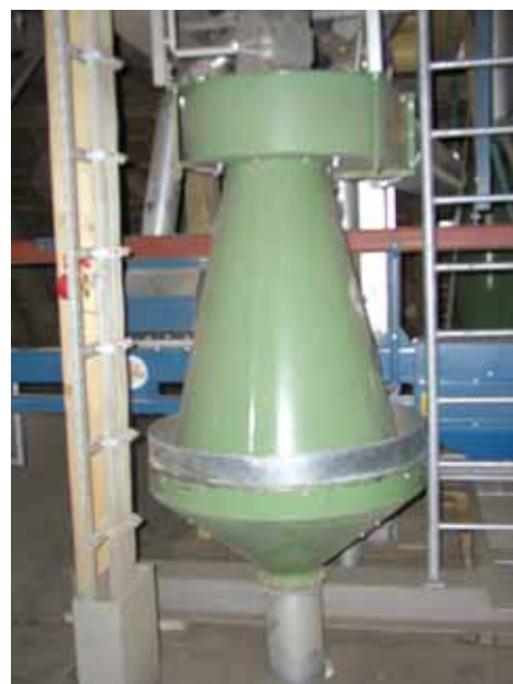
Abb. 3: Funktionsprinzip eines Windsichters zur Reinigung von Getreide vor der Einlagerung (Skizze: Fa. Neuero)
