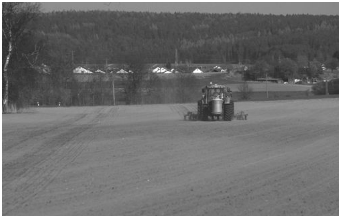
Abb. 3: Säen von Zuckerrüben mit automatischem Lenksystem und Bearbeitung jeder zweiten Spur
