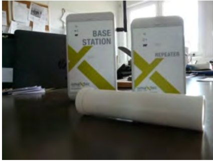
Abb. 2: smaXtec – System zur Messung von Pansen-pH-Wert und Pansentemperatur
