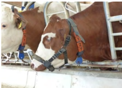
Abb. 3: Rumiwatch-Kauhalfter zur Messung der Kau- und Wiederkauaktivität
