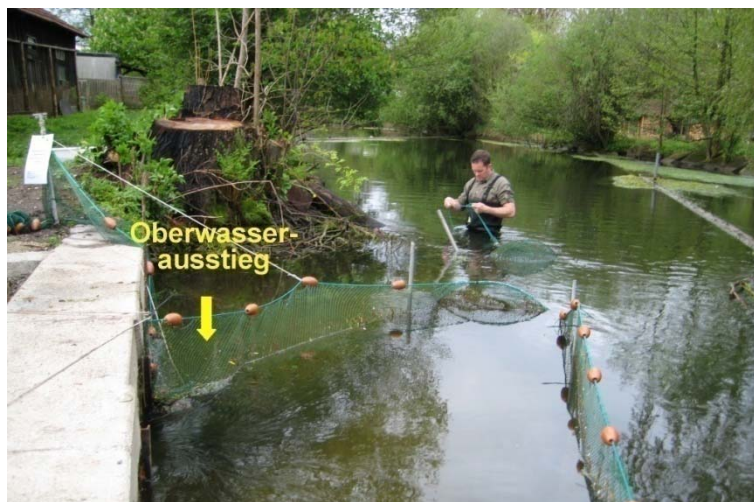
Reusenbefischung zur Funktionskontrolle einer neu errichteten Fischwanderhilfe
