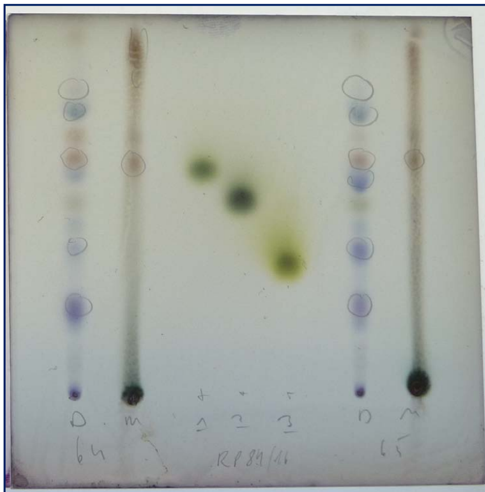
Abb. 18: Dünnschichtchromatographische Untersuchung der Extrakte (Bahn 1, 2, 6, 7), Standards 1-3 (Bahn 3, 4, 5); Phase: Umkehrphase RP18; Laufmittel: ACN/H 2 O 84/16; Spray Anisaldehyd; Detektion: Visuell.
