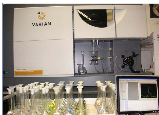
Abb. 14: Königswasserauflösungen von Düngemitteln zur Multielementanalyse am ICP-OES
