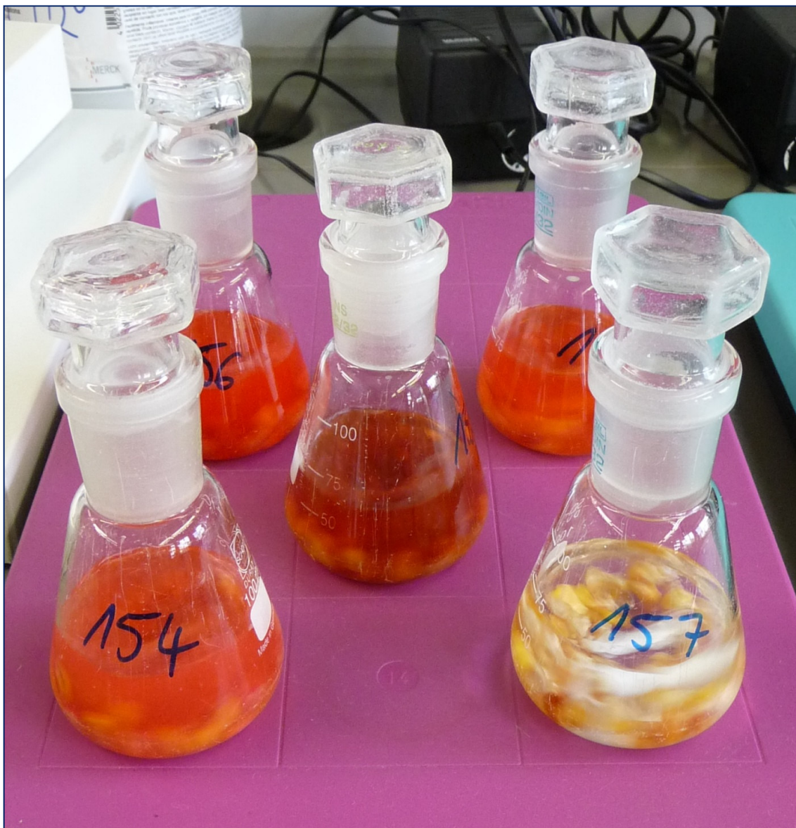
Abb. 15: Extraktion gebeizter Maiskörner mit Rührfisch und Magnetrührer
