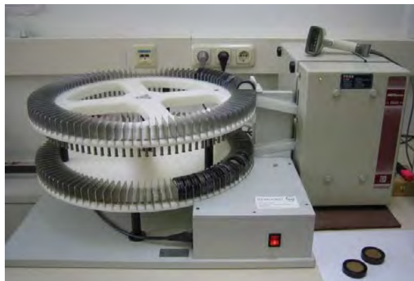
Abb. 73: NIR-Messplatz. Spektrometer mit automatischer Probenzuführung
