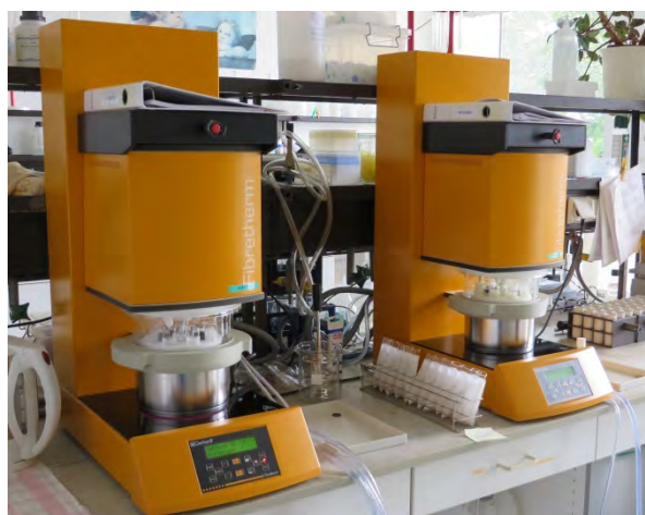
Abb. 68: Automatisch arbeitende Faseranalysatoren der Fa. Gerhardt zur Bestimmung der Analysenparameter ADF_{om} und NDF_{om} .
