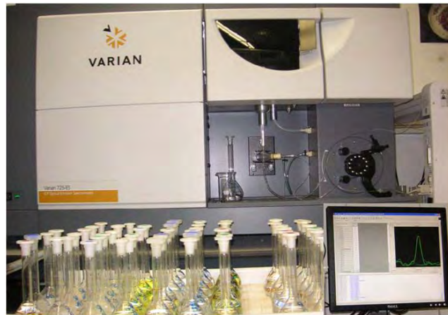
Abb. 27: Königswasseraufschlüsse von Düngemitteln zur Multielementanalyse am ICP-OES
