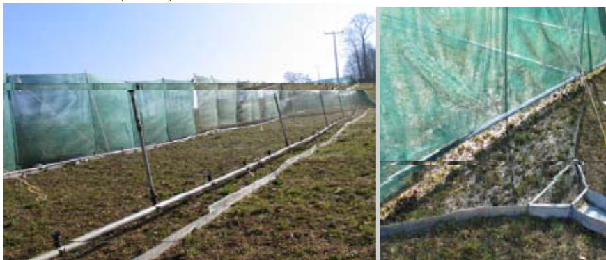
Abbildung 2: Beregnungsanlage mit Windschutz und Leitblechen (links) Detailaufnahme vom trichterförmigen Abflusssammelbereich (rechts)
