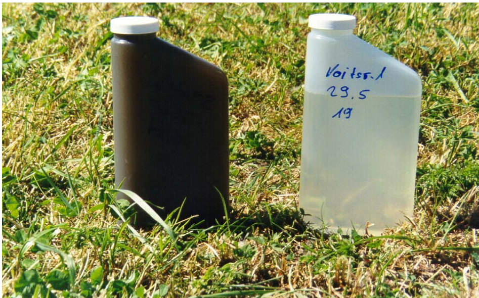
Abb. 38: Wasserproben aus Drainagen nach einem simulierten Starkregenereignis (links nach vorausgegangener Gülleapplikation, rechts nach Beregnung ohne vorheriger Gülleausbringung)
