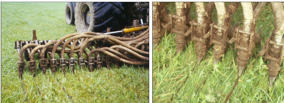
Abb. 8: Gülleausbringung mit flacher Injektion (Schlitztechnik)
