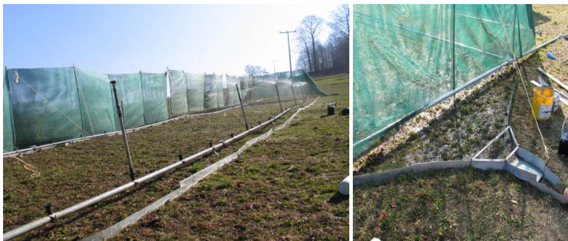
Abb. 11: Beregnungsanlage mit Windschutz und Leitblechen (links) Detailaufnahme vom trichterförmigen Abflusssammelbereich (rechts)
