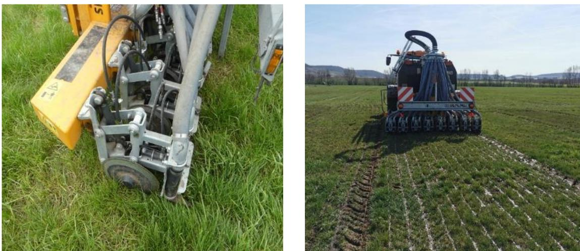
Abbildung 6: Schlitztechnik (Veenhuis) in Detailaufnahme und im Einsatz
