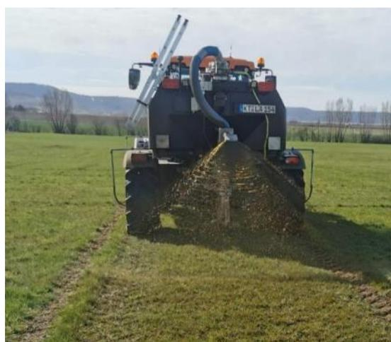
Abbildung 3: Prallteller (Eigenbau) in Detailaufnahme und im Einsatz
