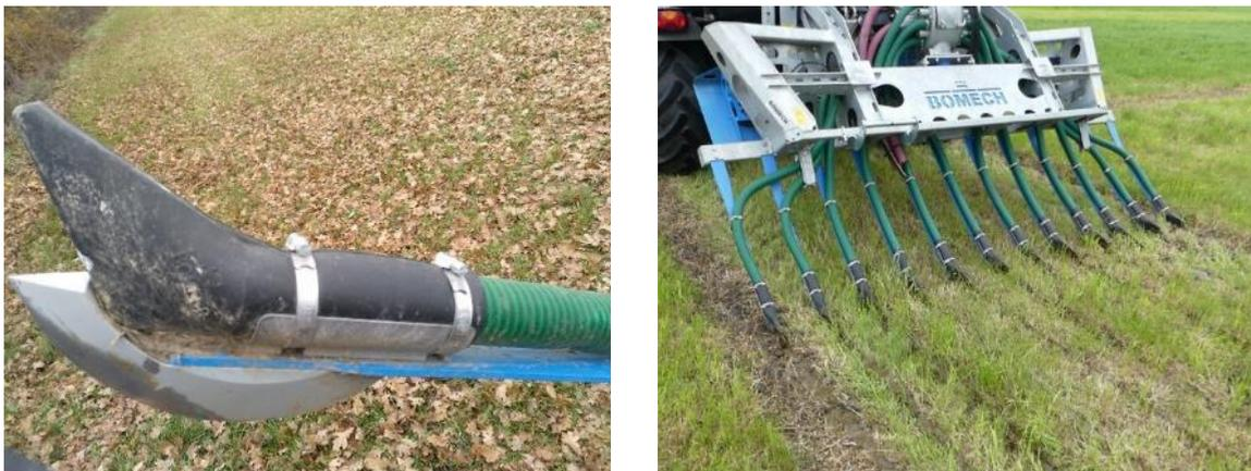
Abbildung 5: Schleppschuh (Bomech) in Detailaufnahme und im Einsatz
