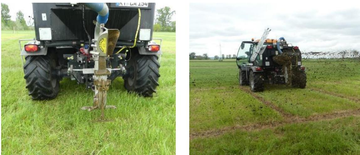
Abbildung 4: Schwenkverteiler (Möscha) in Detailaufnahme und im Einsatz
