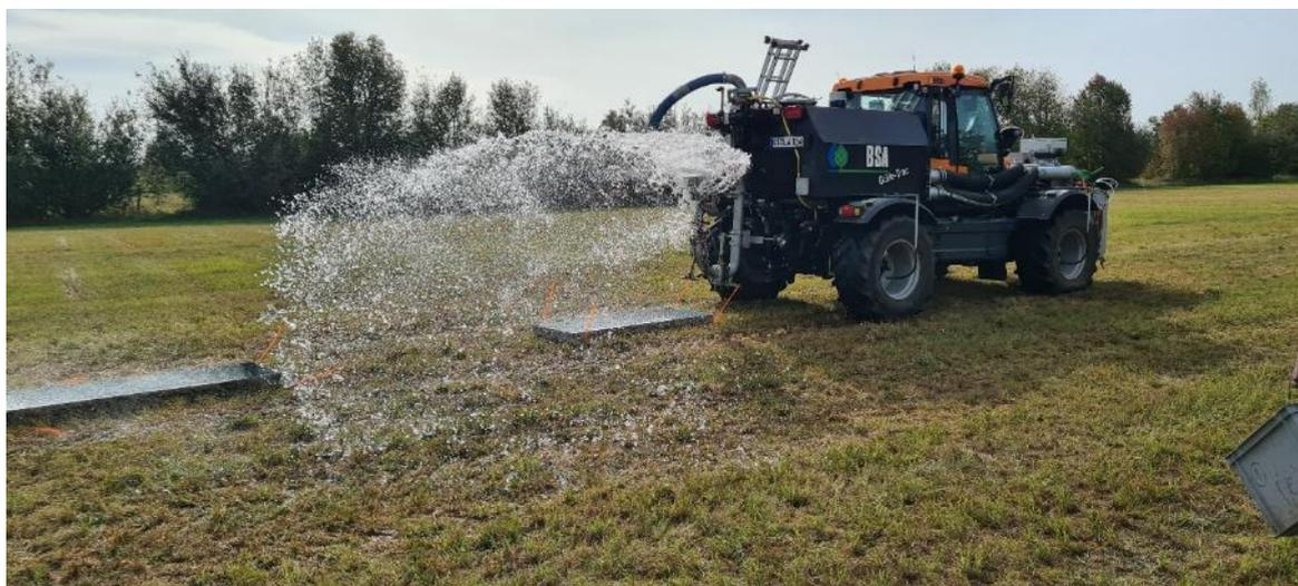
Abbildung 2: Überprüfung der Ausbringgenauigkeit des Schwenkverteilers mit Wasser
