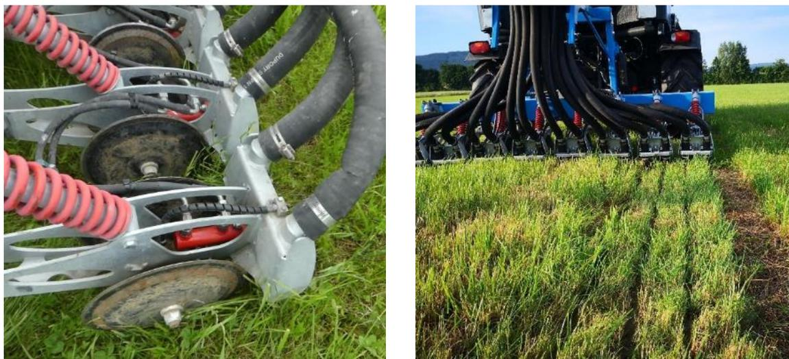
Abbildung 7: Schlitztechnik (Duport) in Detailaufnahme und im Einsatz
