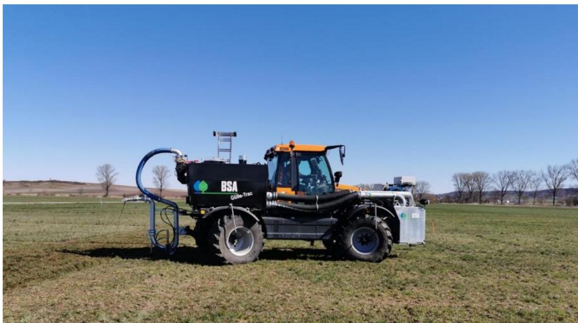
Abbildung 1: Gülletrac mit angebaute Pralltellertechnik im Versuch
