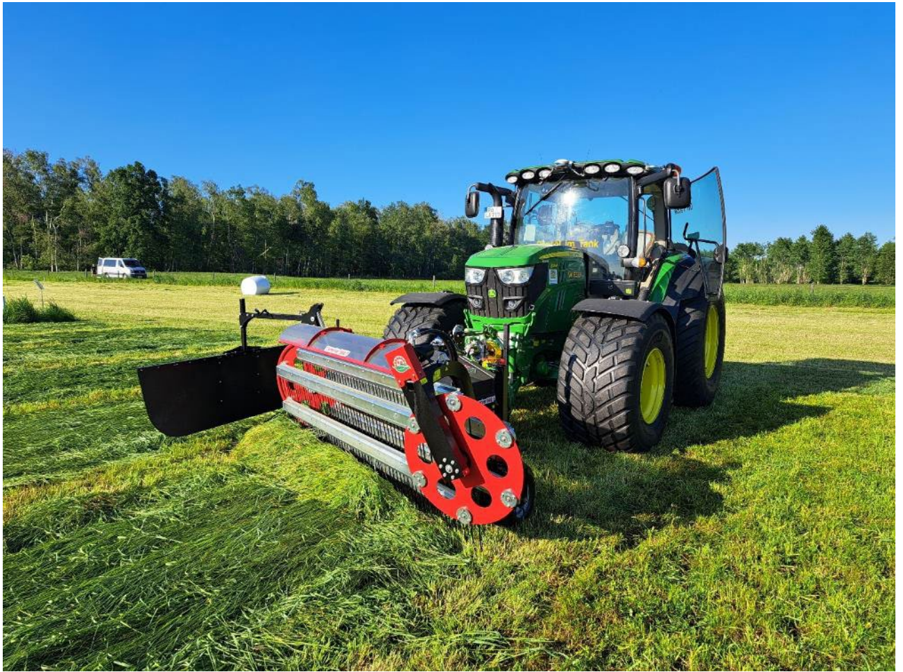
Frontseitenschwader Clementer 300 F: Schwaden ohne Überfahren des Grüngutes, Anheben des Grüngutes beim Seitentransport; 3 m Arbeitsbreite, Gewicht 440 kg
