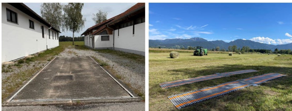
Abbildung 3.35: Fahrwerkswaage der BaySG in Karolinenfeld (links) und mobile Achslastwaage auf den Praxisbetrieben ohne Fahrwerkswaage (rechts) (Bilder: Annika Woortman)
