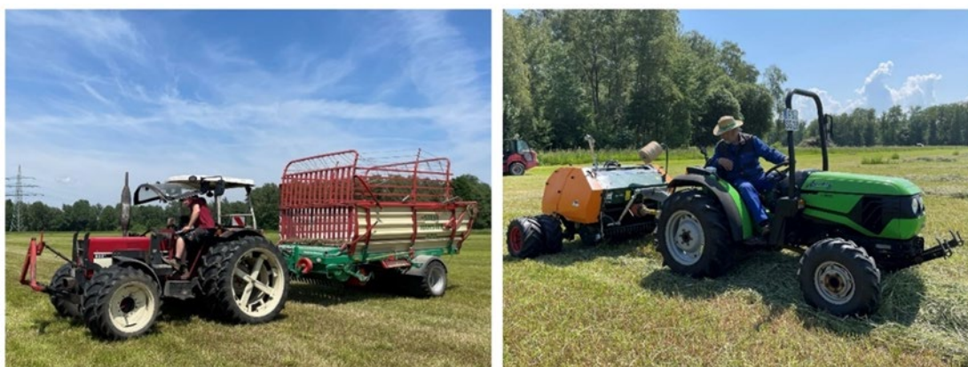
Abbildung 3.16: Leicht angepasste und angepasste Standardtechnik mit einem Steyr Lade-wagen (links) und Spezialtechnik mit Biber Rundballenpresse (rechts) (Bilder: Annika Woortman)
