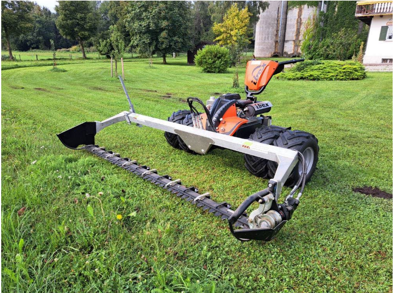
Einachs-Trägerfahrzeug Ibex-Motormäher GS-P mit 3 m Bidux Mähwerk: Ernte Versuchsflächen; 23 PS, 280 kg Gewicht, verschiebbare Achse, mit Doppelbereifung 23x10.50 – 12 AS-Profil
