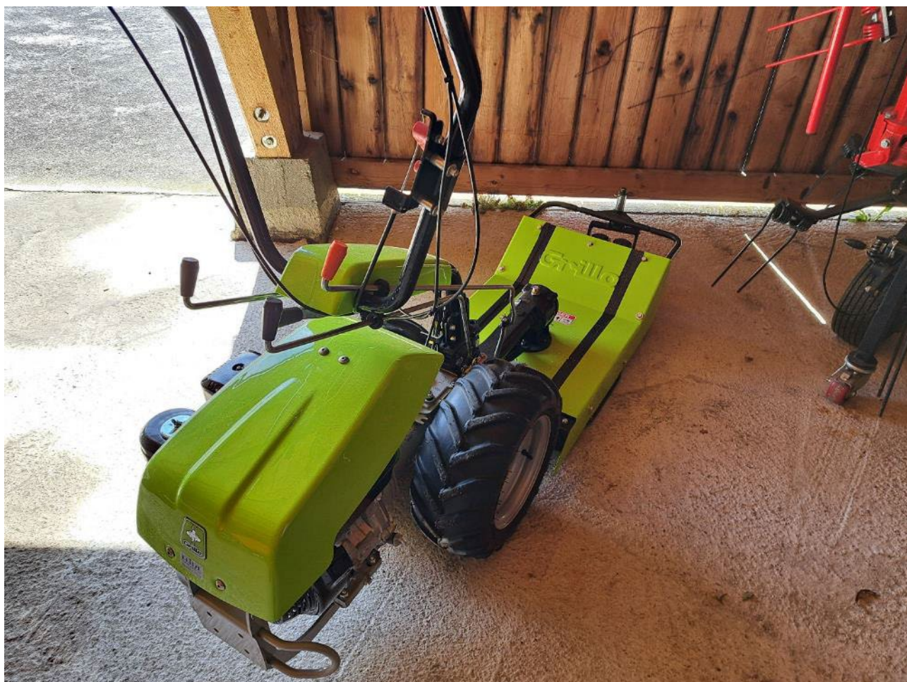
Einachsmulcher/mäher Grillo 85-D Honda GX270: Pflege der Trennwege im Versuch; Arbeitsbreite 50 cm, 9 PS
