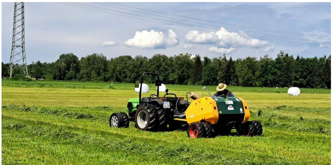
Rundballenpresse Jumbo 1211: Bergung des Aufwuchses der Versuchspartzellen; Ballenlänge 104 cm, Ballendurchmesser 60 cm; Leistungsbedarf ab 30 PS
