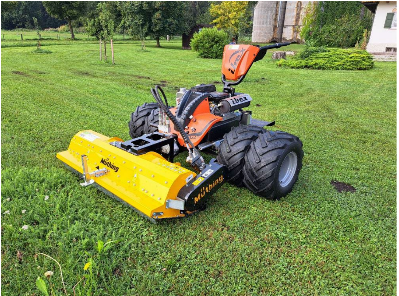
Mulchgerät Müthing MU-C Schlegelmulcher: Pflege Versuchsflächen, Arbeitsbreite 1,6 m; passend für Ibex Trägerfahrzeug; Gewicht 160 kg
