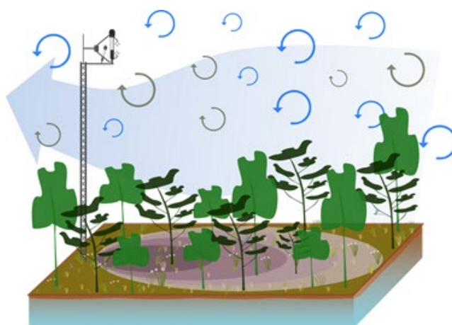
Abbildung 5.7: Messschema für den Stoffaustausch zwischen Ökosystem und Atmosphäre anhand eines Eddy-Kovarianz-Turms mit Gasanalysator und 3D-Ultraschallanemometer (Peatland Science Centre, 2024).
