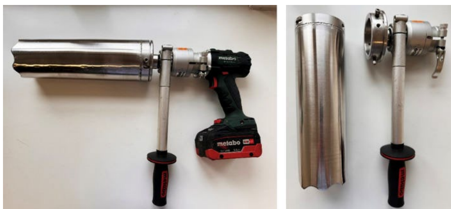
Abbildung 3.31: Metabo Bohrmaschine mit angebautem Bohraufsatz zur Siloballenbeprobung (Bilder: Annika Woortman)
