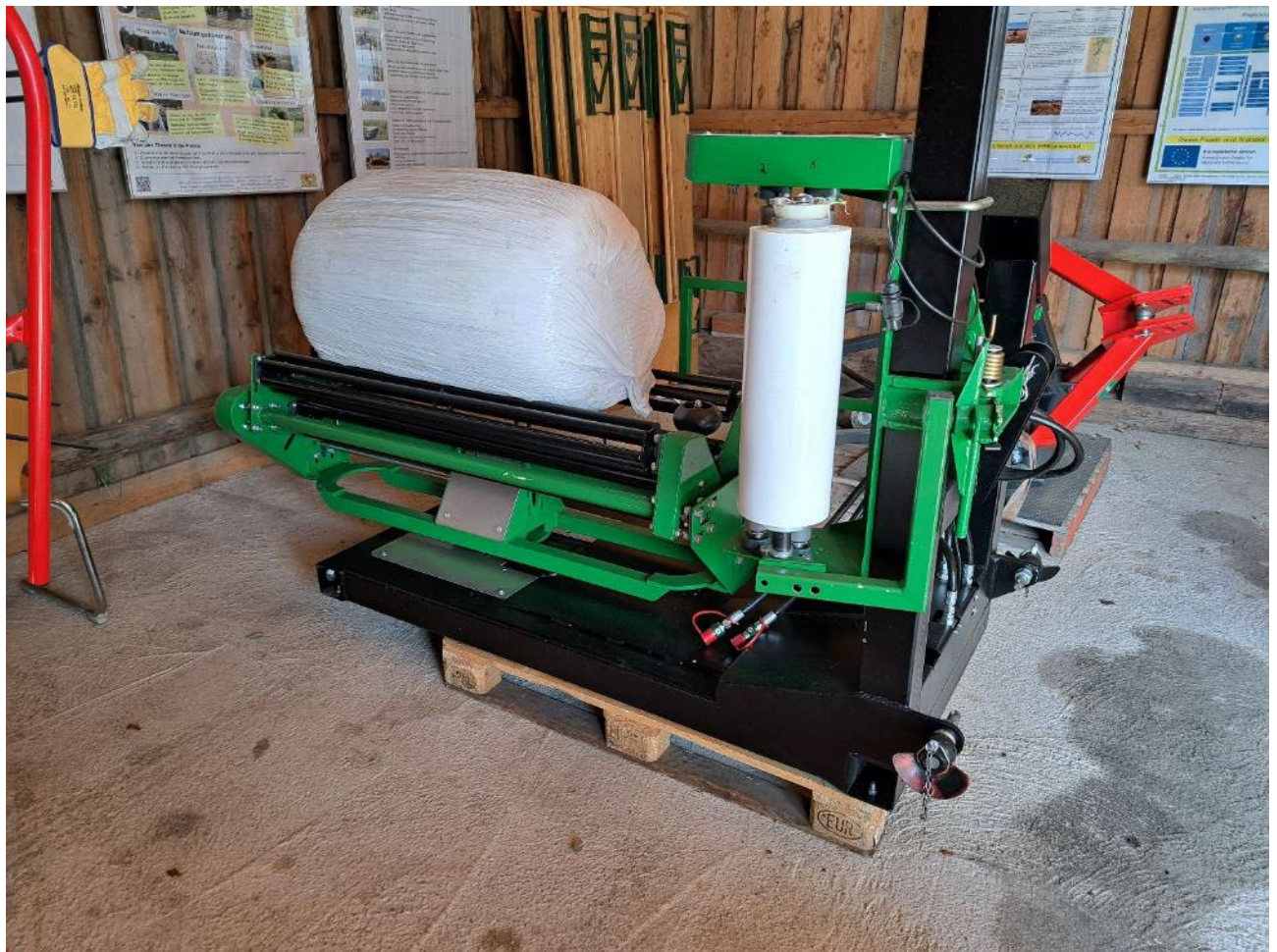
Miniballenwickelgerät Lambers: Bergung des Aufwuchses der Versuchspartzellen, Ballengewicht max. 50 kg; Ballendurchmesser max. 85 cm
