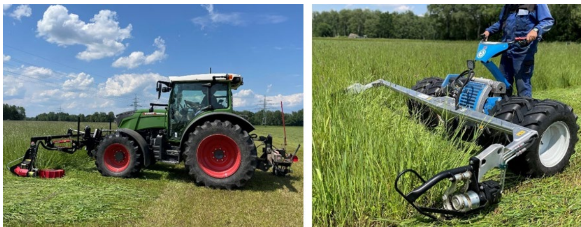
Abbildung 3.13: Fendt 211 Traktor mit Secco Duplex 310F Doppelmesser Frontmäherwerk und Secco Duplex 335H Heckmäherwerk (links) und Brielmaier Motormäher mit BB-Umwelttechnik Doppelmesser (rechts) (Bilder: Annika Woortman)
