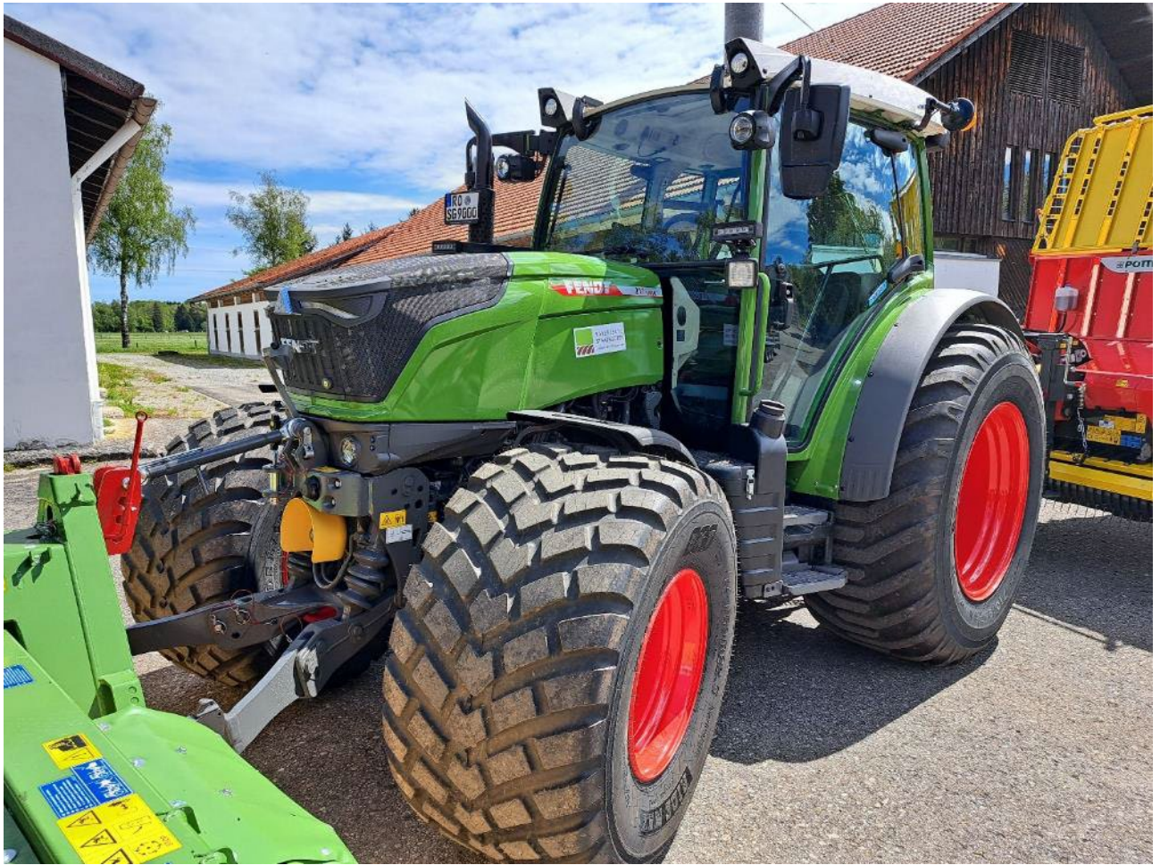
Grünlandtraktor Fendt 211 S Vario GEN3: Bearbeitung Versuchsflächen und Großflächen; HVO-tauglich, 124 PS; Bodendruck mit Breitreifung max. 0,13 kp/cm 2 ; 3,9 to Leergewicht; Load-Sensing;
