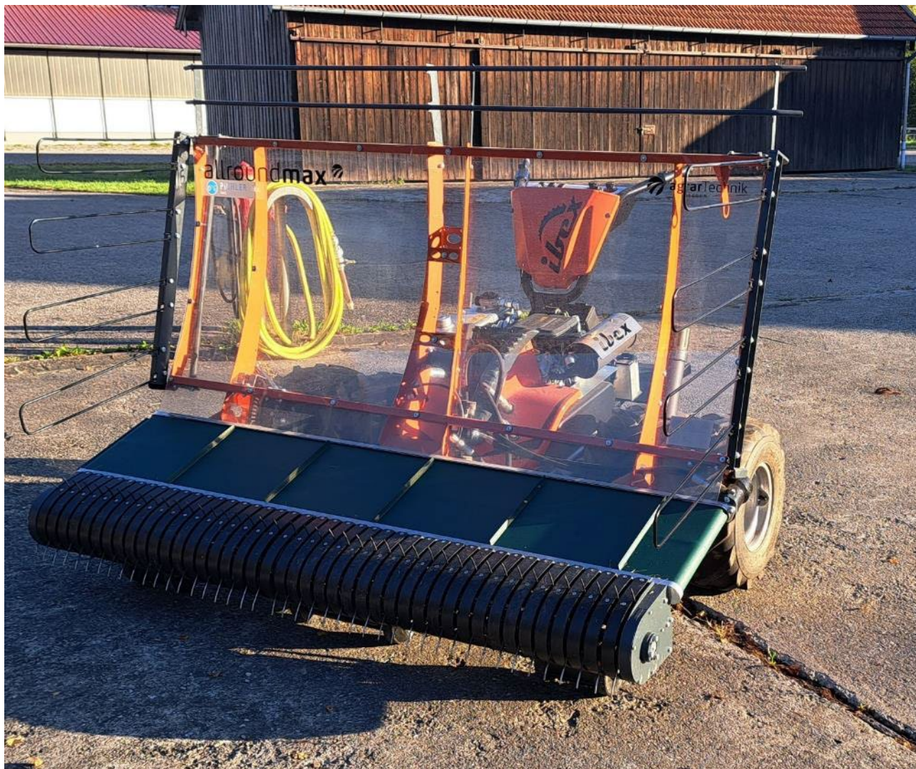
Heuschieber Seeber AllroundMax: zur Aufnahme und seitlichem Transport von Grüngut; Arbeitsbreite 2,35 m; Gerätetiefe 90 cm, Förderbandbreite 40 cm
