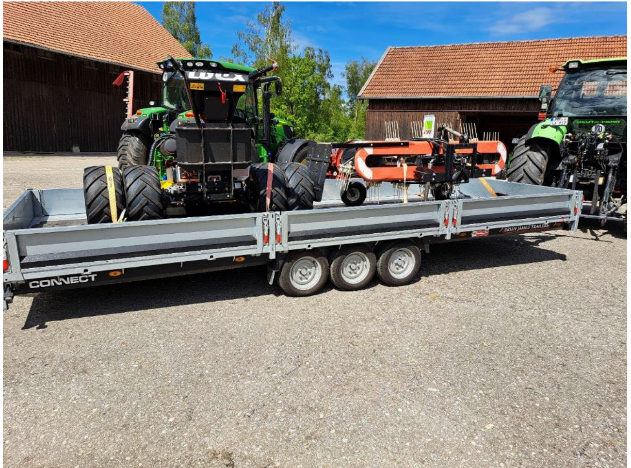
Pkw-Anhänger Raith: Transportanhänger, Ladefläche Länge 6 m, Ladefläche Breite 2,27 m (Innenmaße)
