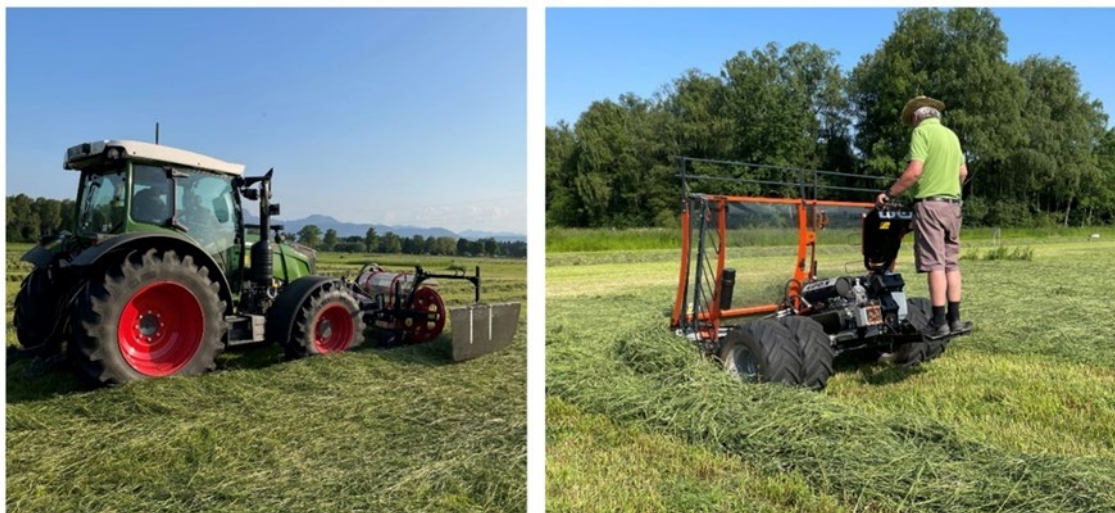
Abbildung 3.15: Leicht angepasste und angepasste Standardtechnik mit einem Kamm-schwader von BB-Umwelttechnik (links) und Spezialtechnik mit dem AllroundMax Heu-schieber von Seeber (rechts) (Bilder: Annika Woortman)
