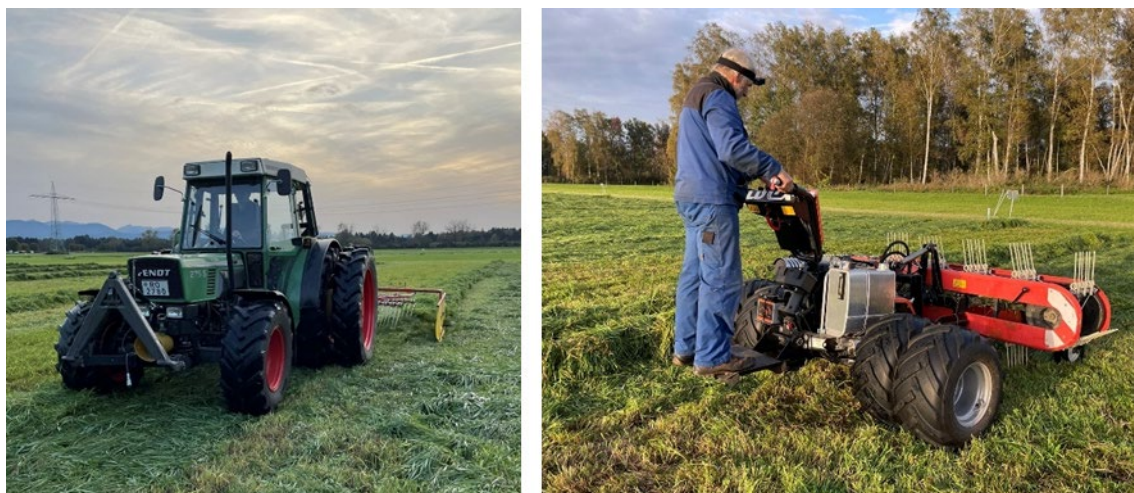
Abbildung 3.21: Fendt 275 S Traktor mit einem Pöttinger TOP 42 N Kreiselschwader (links) und IBEX-Motormäher mit Reform Bandrechen (rechts) (Bilder: Annika Woortman)
