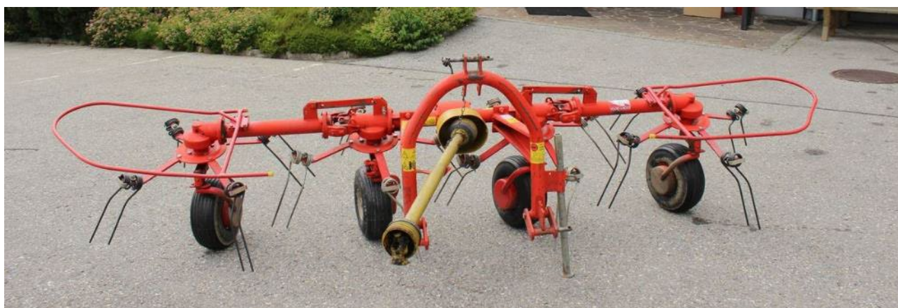
Kreiselheuer SIP Spider 350/4 Alp H: Aufbereitung Grüngut auf den Versuchsflächen; Arbeitsbreite 2,7 m, Gewicht 270 kg, Leistungsbedarf 15 PS
