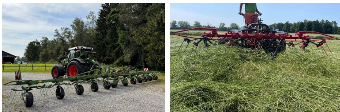
Abbildung 3.14: Traktor mit Standardbereifung vorne und hinten und einem Krone KW 13.02/12T Kreiselzettwender (links) und Ibex Einachsmotormäher mit einem Kreiselzettwender SIP (Spinder 350/4 Alp H Zetter) (rechts) (Bilder: Annika Woortman)
