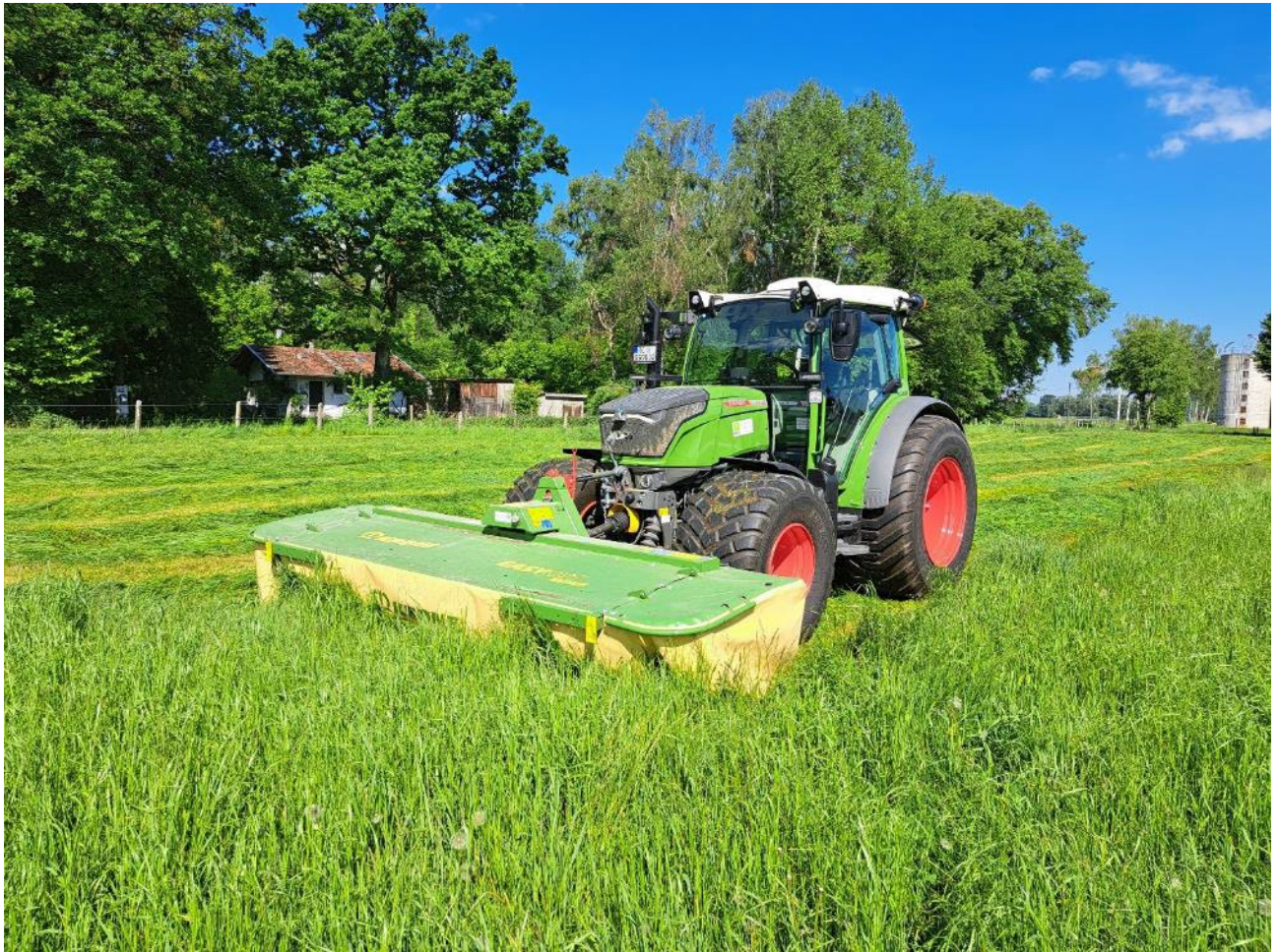
Frontmähwerk Krone EC F 320M: Beerntung Großflächen und Versuchsflächen; leichtes Scheibenmähwerk (Alpin-Ausführung) ohne Aufbereiter; Arbeitsbreite 3,16 m; Gewicht 680 kg
