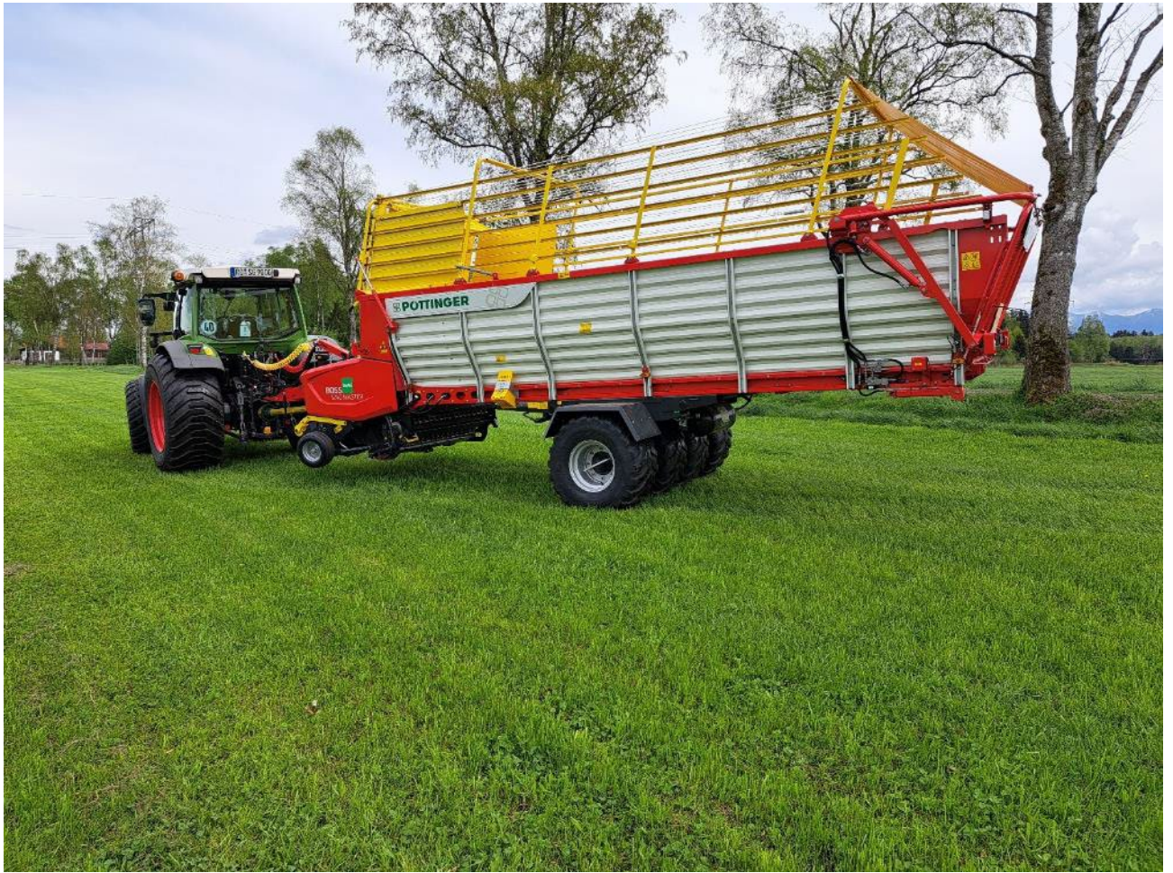
Ladewagen BOSS 3240 Master Pöttinger: Bergung des Aufwuchses auf Großflächen; 4-Rad-Kurmann-Spezialfahrwerk 10S 08-208, Bereifung 520/50R17; Load-Sensing, Gewicht 3,8 to
