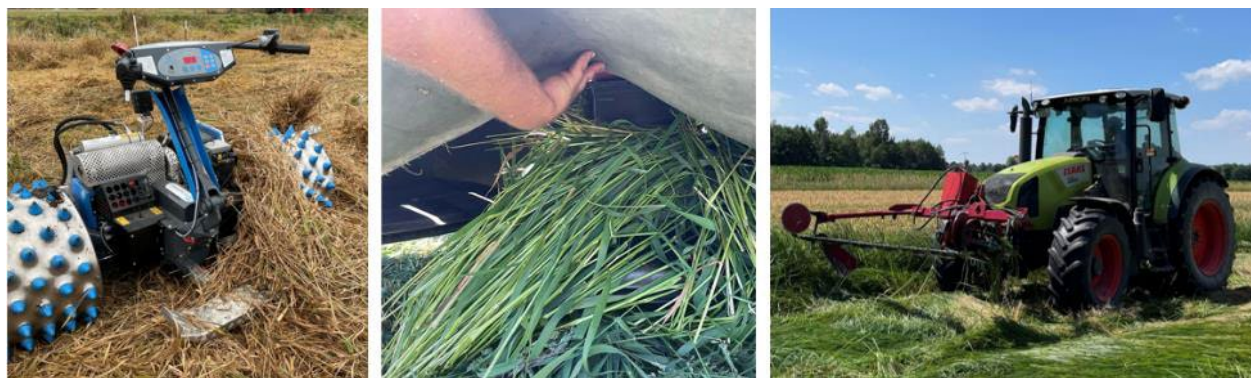
Abbildung 4.23: Brielmaier Einachsmäher mit umwickeltem Erntegut (links), mitte: verstopftes Trommelmähwerk (mitte), Traktor mit Doppelmesser (rechts)
