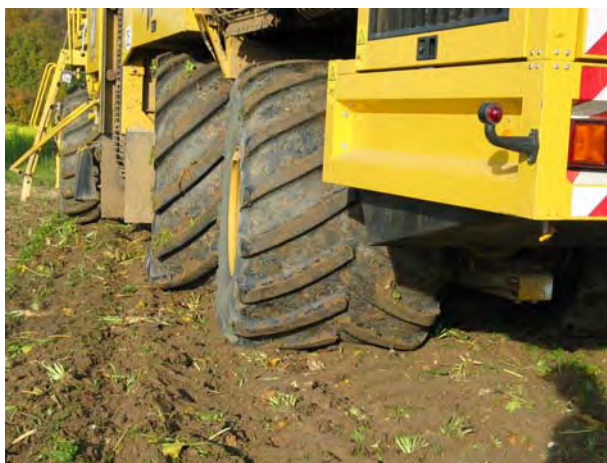
Abb. 13: Verteilung der Lasten auf 3 Achsen
