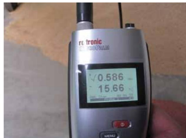
*Bei einer Temperatur des Weizens im Lager von 15,66 °C liegt in diesem Flachlager zum Zeitpunkt der Messung der aw-Wert mit 0,586 deutlich unter der Grenze von 0,65. Foto: Gengenbach, LLH*
