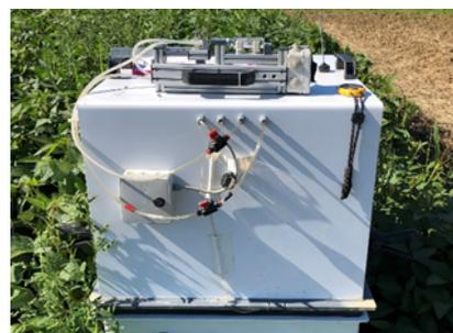
Abb. 1 Messung von Lachgasflüssen in Sojabohnen mit der Closed-Chamber Methode
