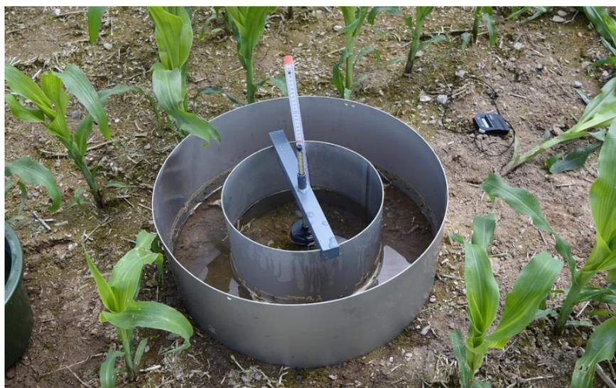
Abb. 1: Messung der Infiltrationsrate mit einem Doppelringfiltrimeter
