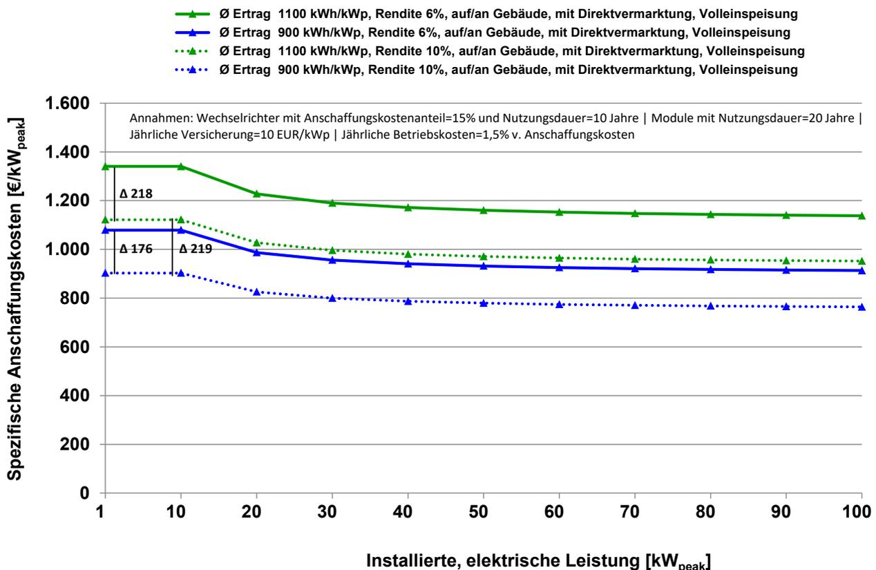
Abbildung 1: „Höchstens tragbare“ Anschaffungskosten einer PV-Dachanlage mit Volleinspeisung bis 100 kW<sub>p</sub> im Zeitraum Januar 2023 bis Januar 2024
