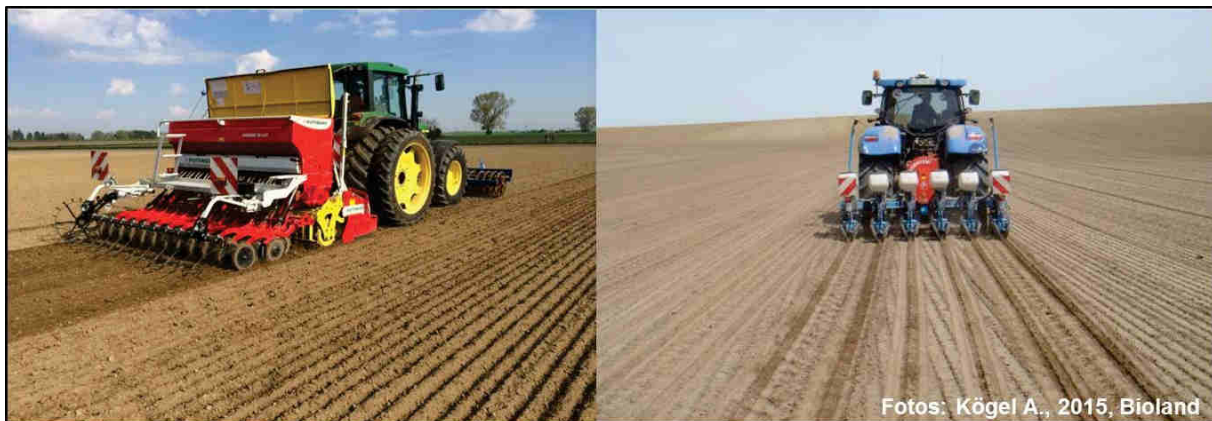
Abb. 4: Drillsaat (links) und Einzelkornsaat (rechts) sind die am häufigsten eingesetzten Sätechniken im Sojabohnenanbau
