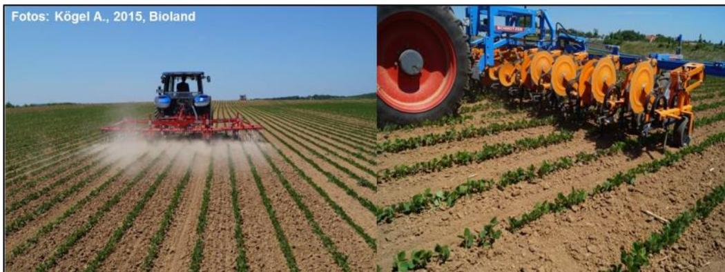
Abb. 1 Einsatz von Striegel (Bild links) und Hacke (Bild rechts) im Sojabestand
