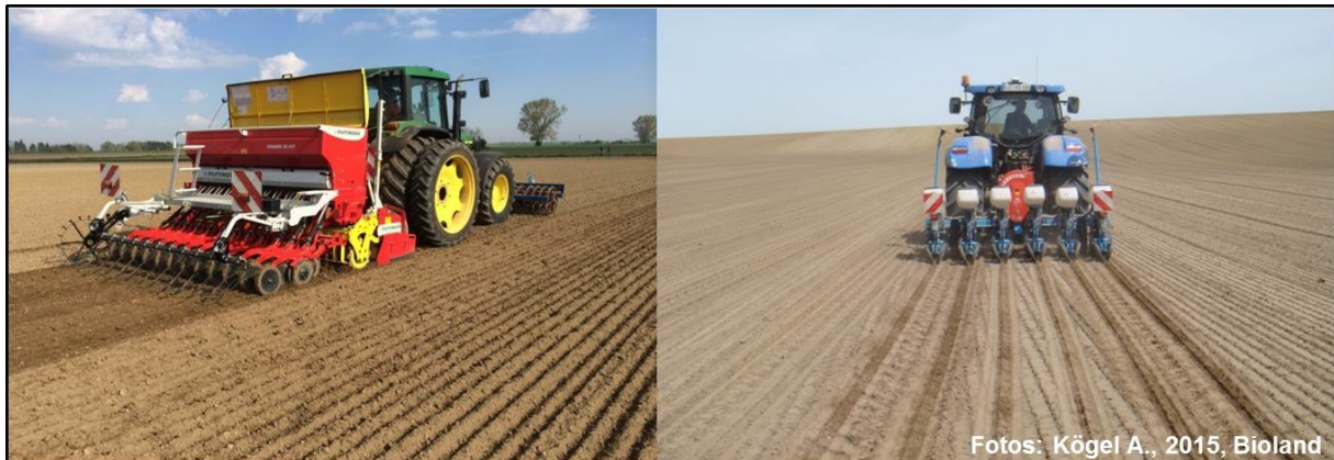
Abb. 1 Drillsaat (links) und Einzelkornsaat (rechts) sind die am häufigsten eingesetzten Sätechniken bei Sojabohnen
