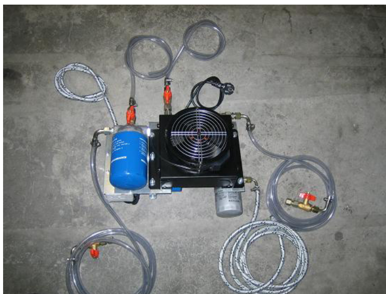
Abb. 12: Vorrichtung der Firma H-J Schnell zur Integration der Zündölwiegevorrichtung in die bestehende Zündölleitung von Zündstrahl-BHKW
