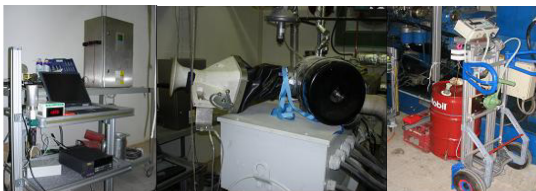
Abb. 10: Messgeräte für Gaskomponenten, Luftzufuhr und Zündölmenge im Praxiseinsatz
