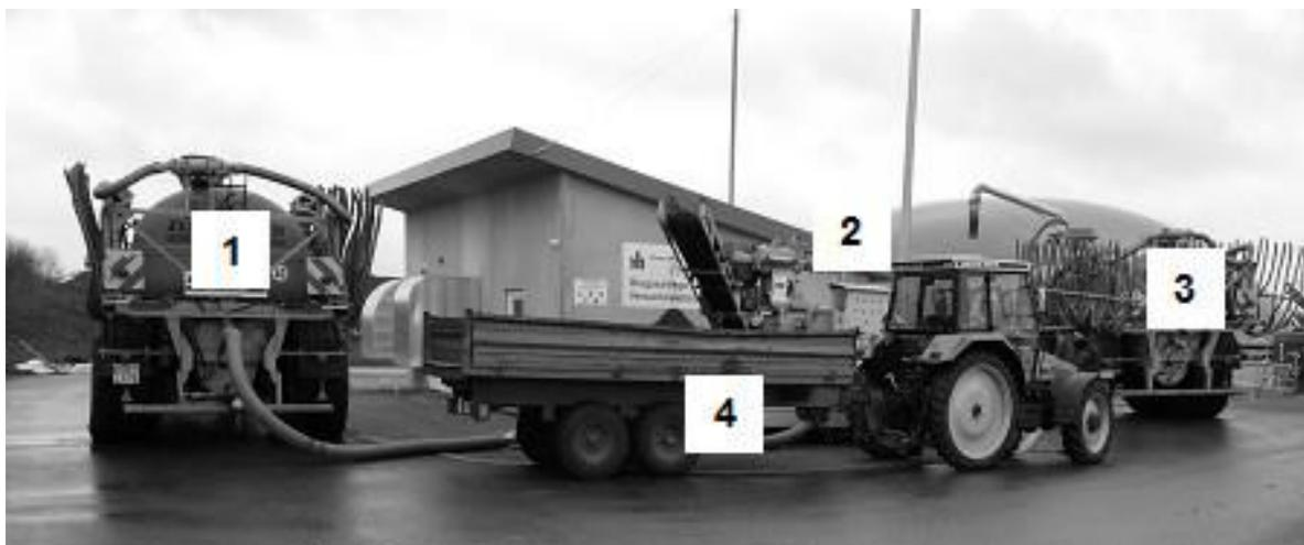
Abbildung 3: Versuchsaufbau zur Massenbilanzierung sowie zur Erfassung der Verfahrenskennwerte bei der Wirtschaftsdüngeraufbereitung mit einem Pressschneckenseparator
