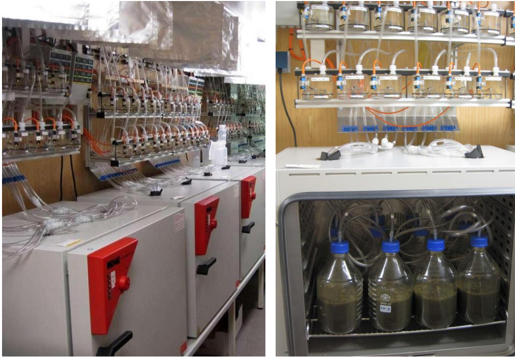
Abbildung 1: Versuchsaufbau zur Messung des Restgaspotentials an der LfL und Innenansicht des Wärmeschanks mit den gefüllten Glasfermentern.
