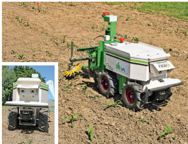
Der Mini-Roboter Naio Oz 440 hat vorne „drei Augen“: Neben den beiden Kameras hat er auch noch ein Lasersystem.
