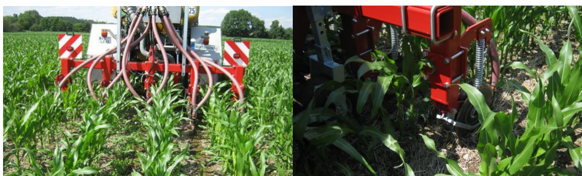
Abb. 16: Schwerer Scheibeninjektor bei der Reihendüngung im 80 cm hohen Bestand
