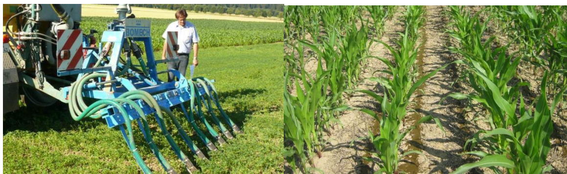
Abb. 14: Der Schleppschuhverteiler legt die Gülle jeweils links und rechts der Pflanzen ab
