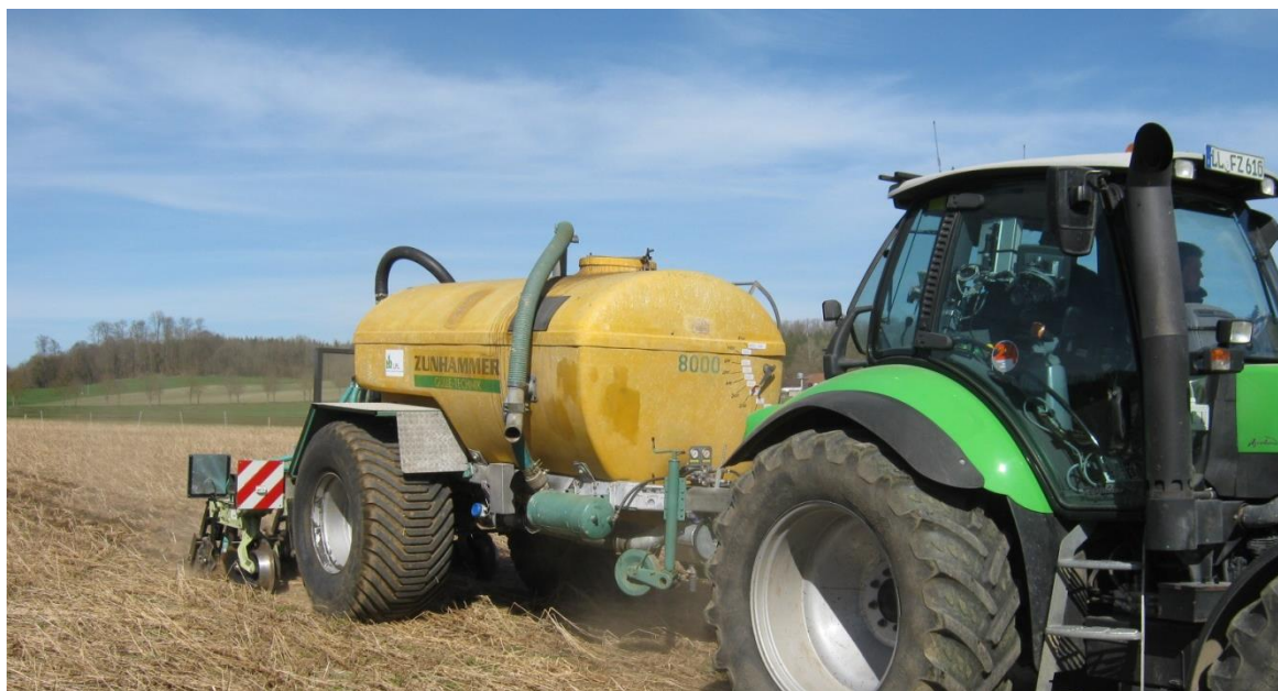
Abb. 8: Pumptankwagen mit Breitreifen mit 8000 l Fassungsvermögen für Versuche
