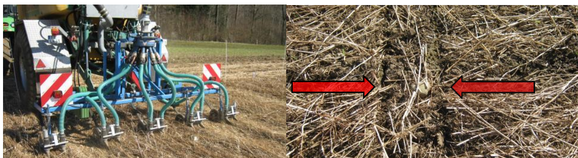
Abb. 12: Gülleausbringung mit leichtem Scheibeninjektor: Die vorauslaufenden Scheiben durchschneiden die oberflächliche Mulchschicht (rote Pfeile)
