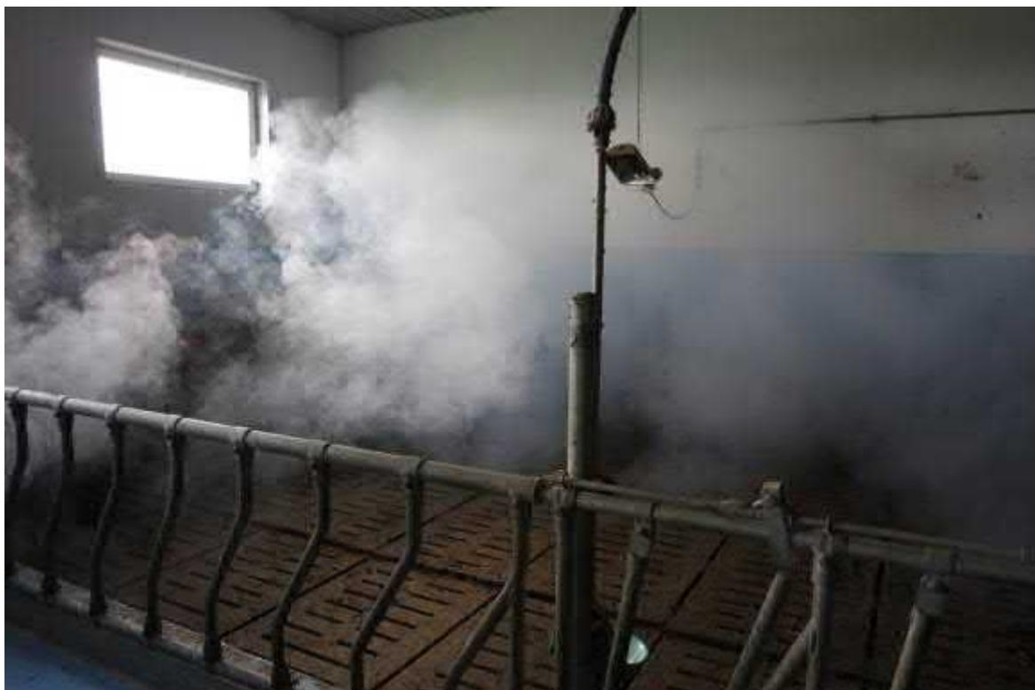
Abb. 7: Rauchprobe zur Visualisierung der Luftführung im Betrieb 2
