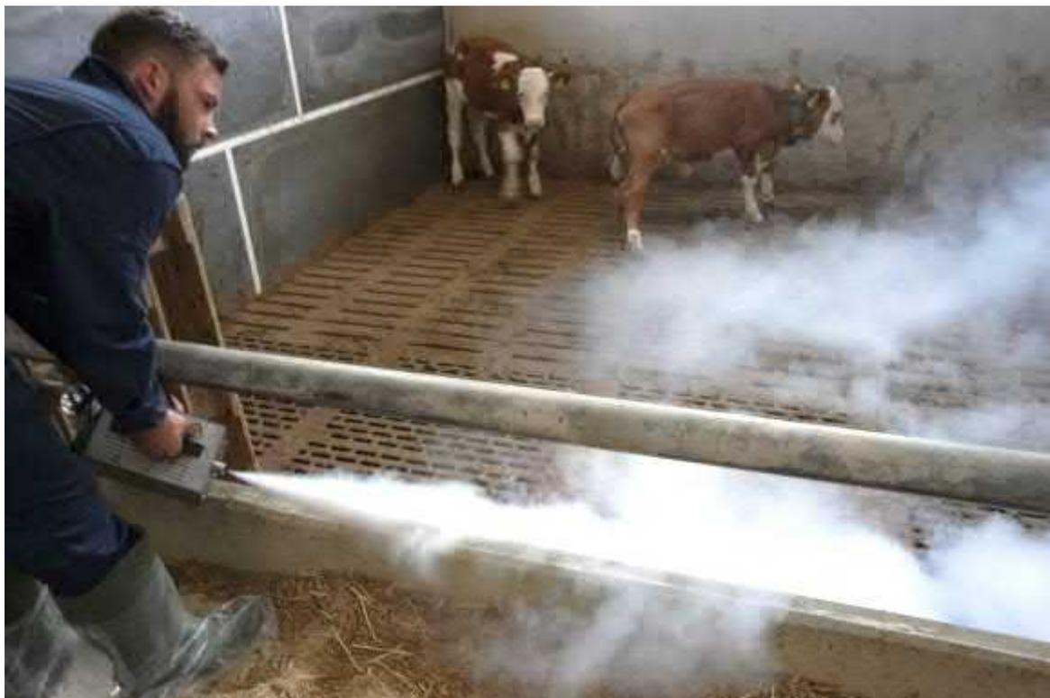
*Abb. 6: Rauchprobe zur Visualisierung der Luftführung im Betrieb 1*
