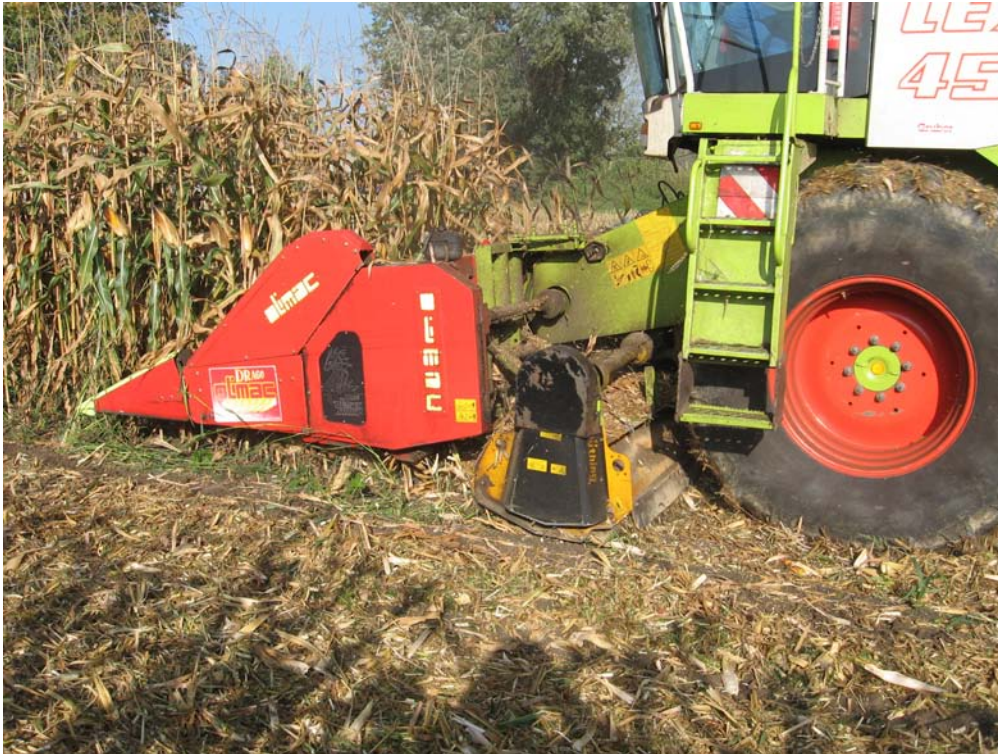
Abbildung 2: Am Schrägförderer links und rechts angebrachte Mulchgeräte
