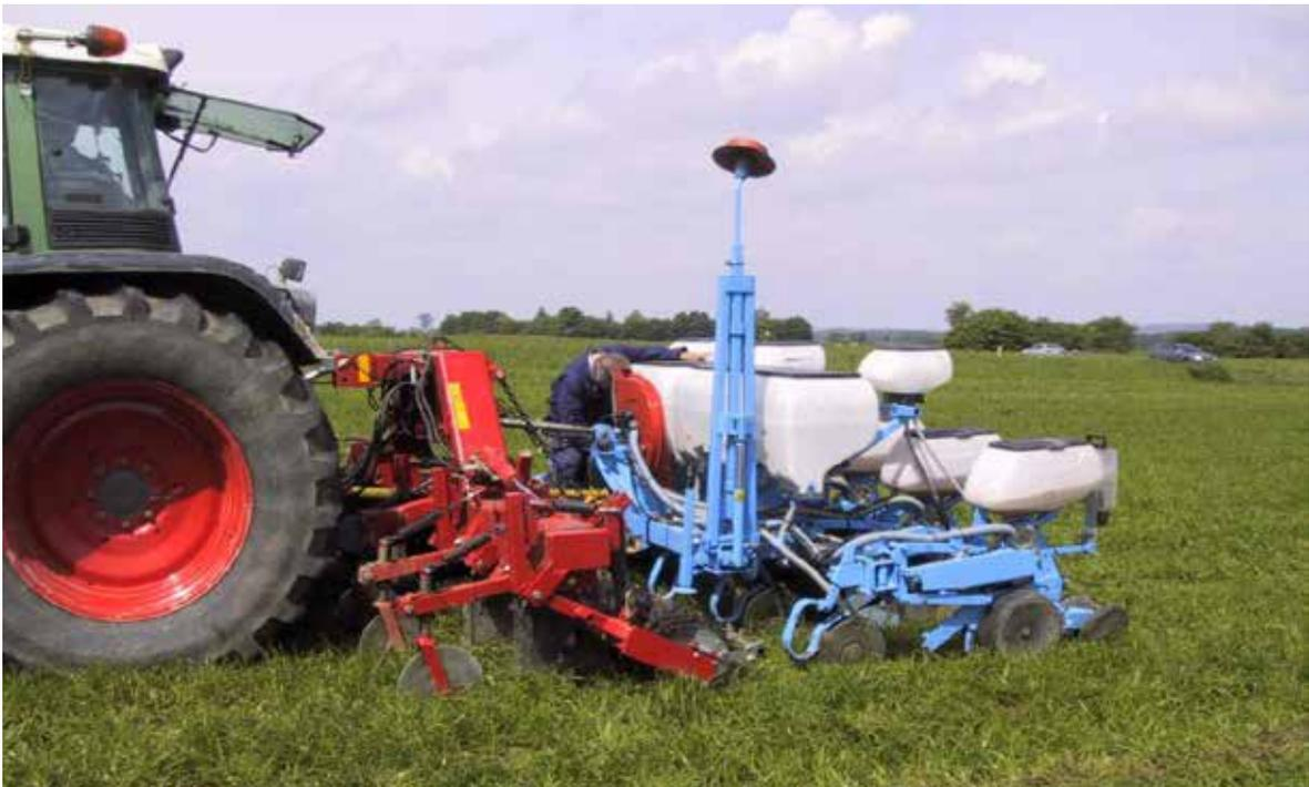
**Abbildung 3: Vorlockerer Evers „Hunter“ mit Einzelkornsägerät (2005)**
