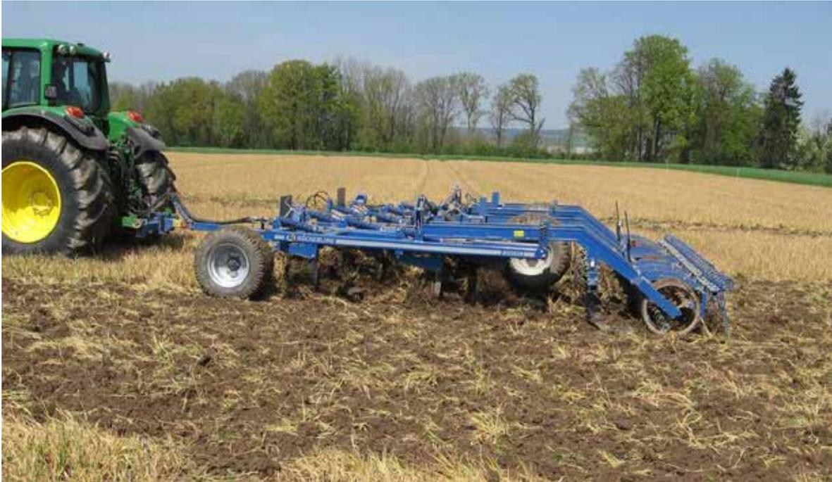
**Abbildung 30: Bodenbearbeitung mit schwerem Grubber**
