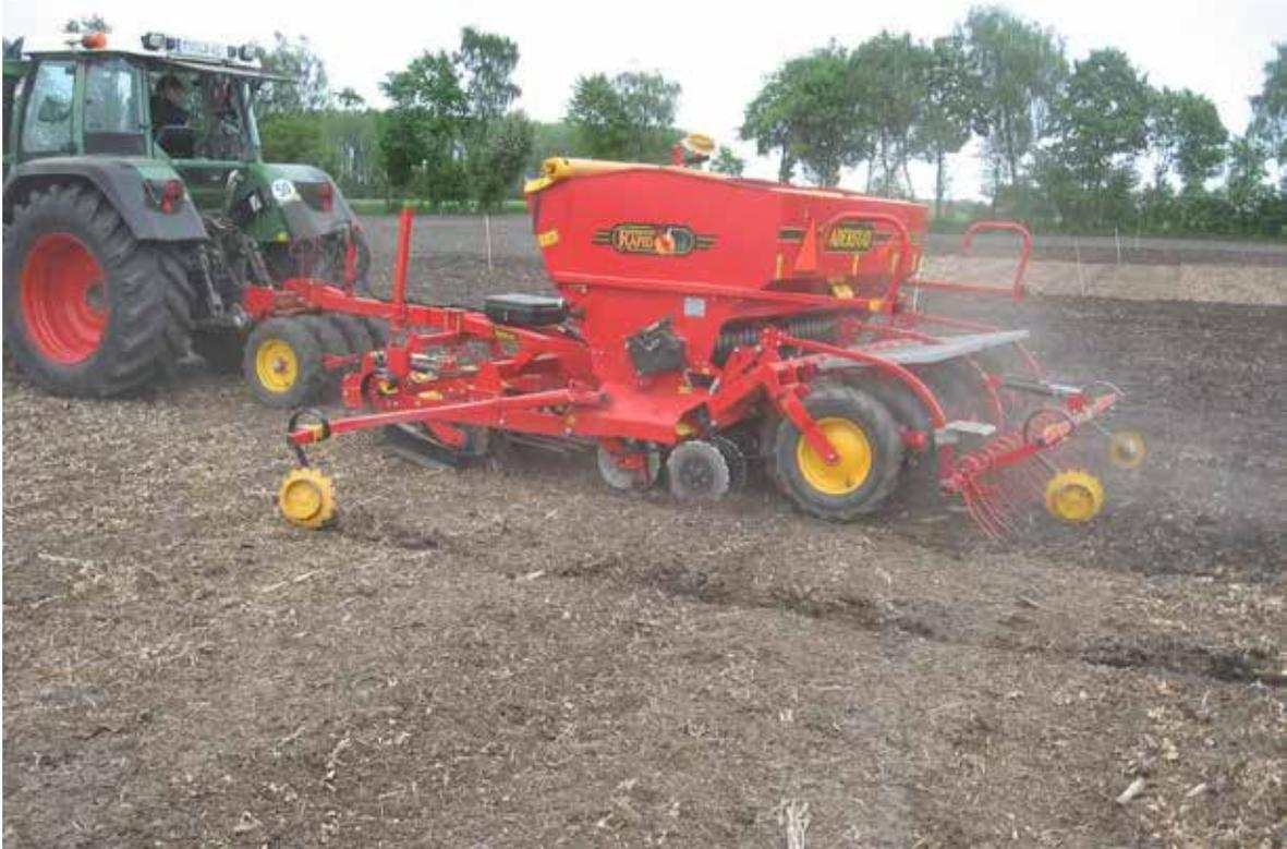
**Abbildung 21: Scheiben-Drillmaschine ohne Saatbettbereitung (2009)**
