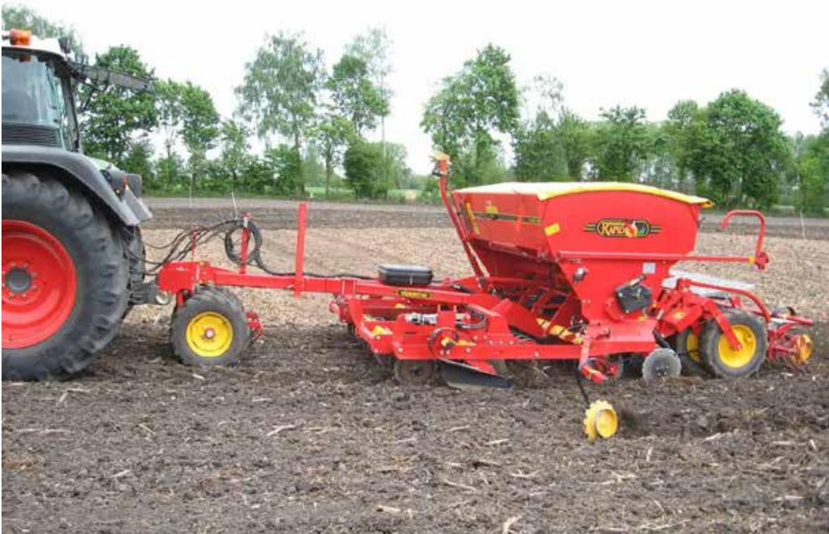
**Abbildung 20: Scheiben-Drillmaschine mit Saatbettbereitung (2009)**
