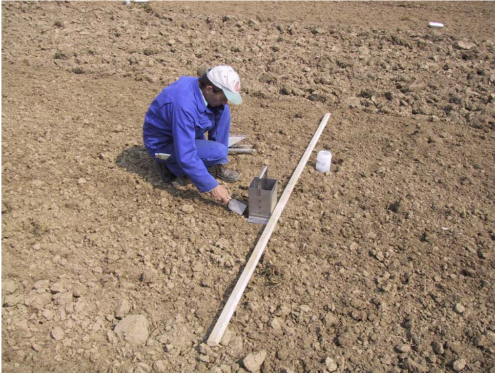
Abbildung 4: Probennahme für die Bestimmung der Krümelung
