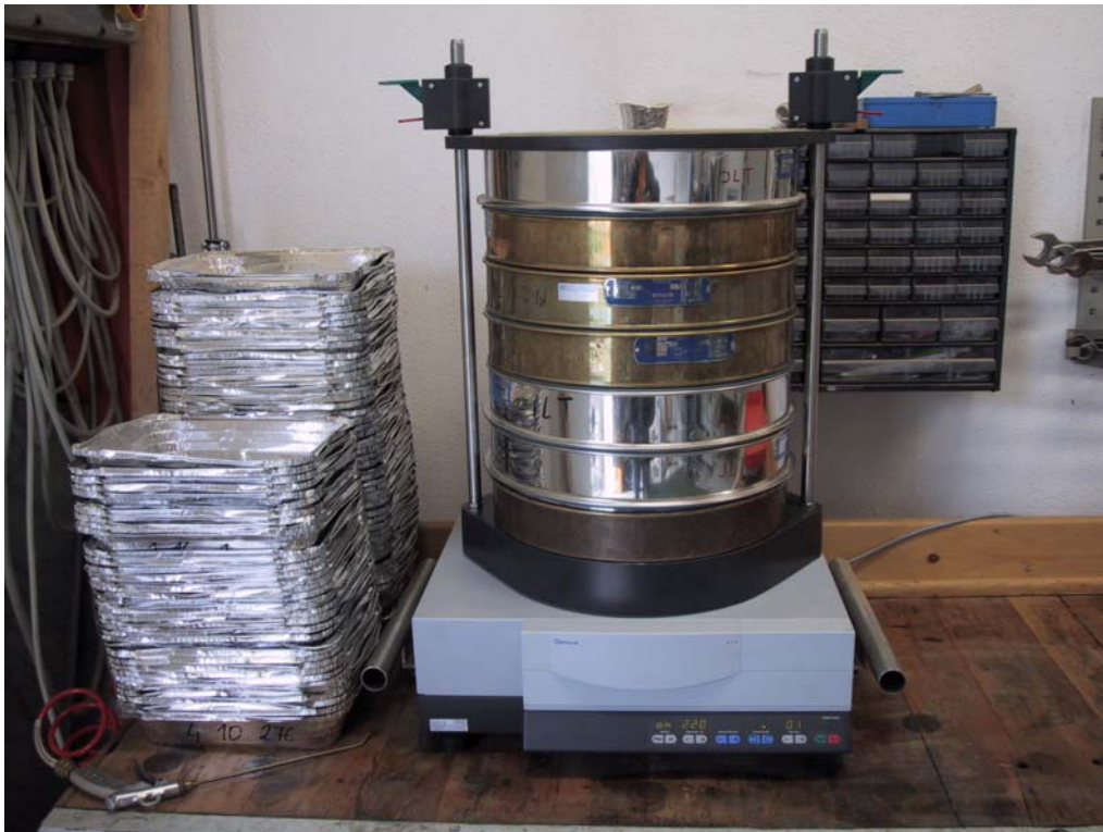
Abbildung 7: Analysensiebmaschine mit aufgebautem Siebturm
