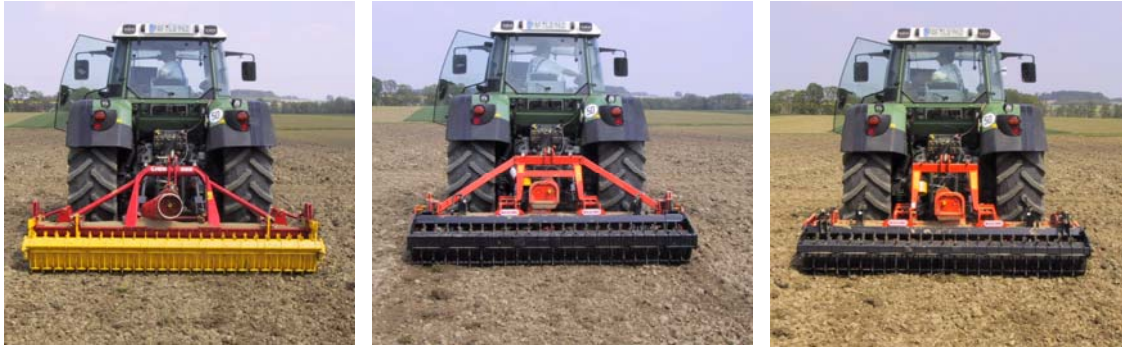
Abbildung 1: Untersuchte Kreiseleggen mit 10,12 und 14 Kreisel (v. l.: Lion 300, DC-V 3000, HB 3000 Z)
