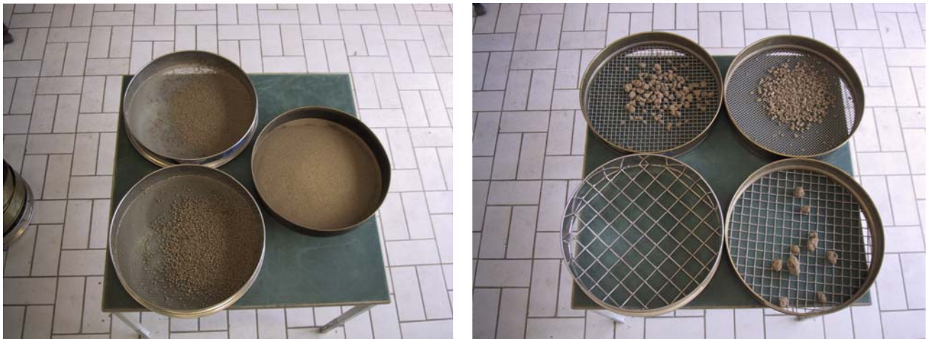
Abbildung 8: Siebfractionen (li.: >1,25/1,25/2,5 mm – re.: 5/10/20/40 mm)
