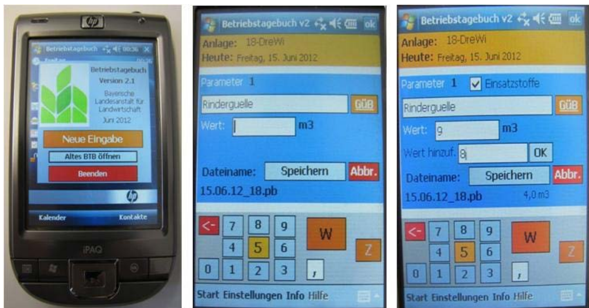
Abb. 12: Start- und Eingabemasken des elektronischen Betriebstagebuchs für PDA
