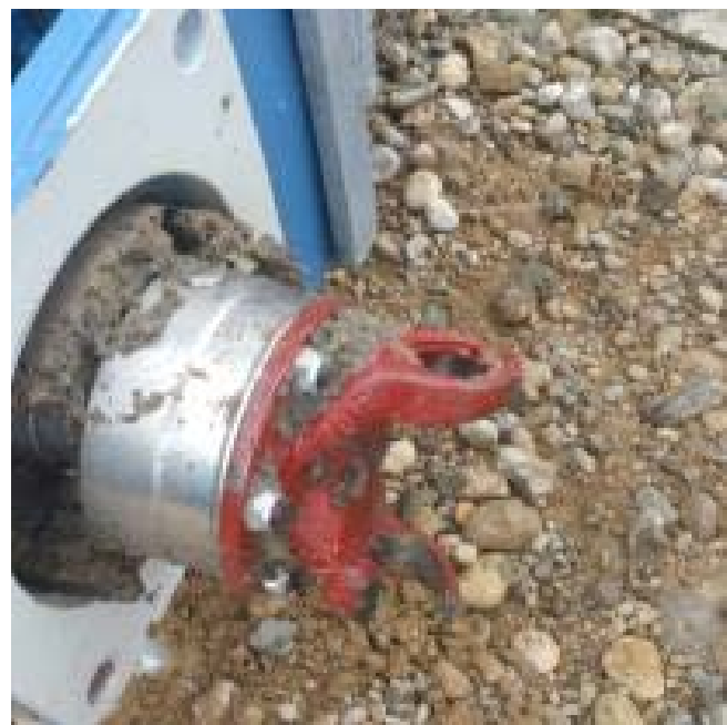
Abbildung 7: Gebrochenes Kardangelenk der Zuckerrübenpumpe
