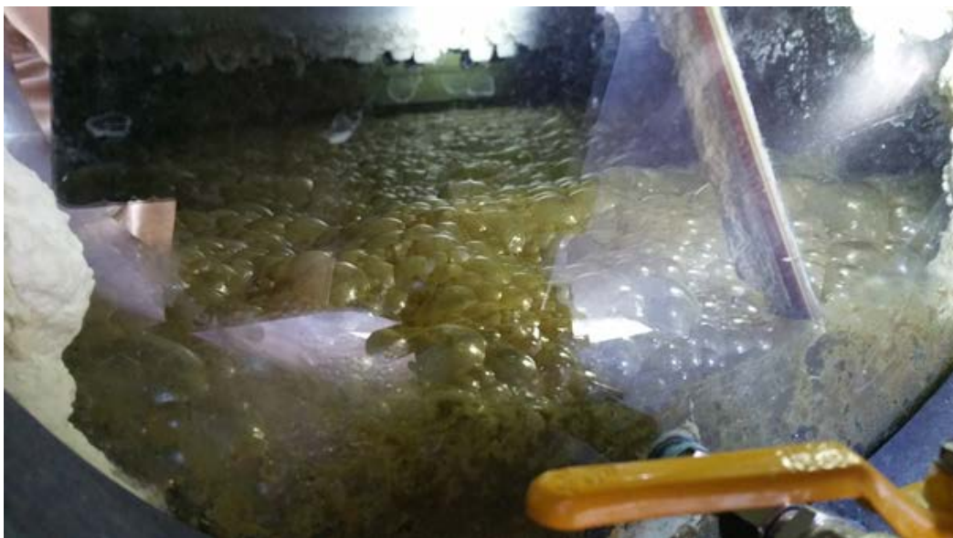
Abbildung 23: Erkennbare Schaumschicht im Fermenter
