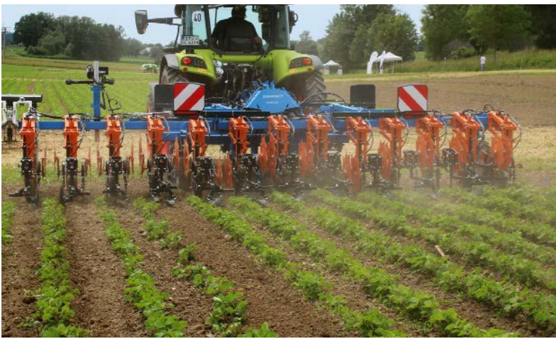
Schmotzer Venterra 2K: Die Serie mit bis zu 6,75 m Arbeitsbreite kombiniert einen sehr hohen Durchgang mit einer Aushubhöhe der Parallelogramme von fast 50 cm. Reihengeführt wird sie über ein Kamera-System, das auch bei sehr hohen Arbeitsgeschwindigkeiten eine dauerhaft exakte Führung garantieren soll.
