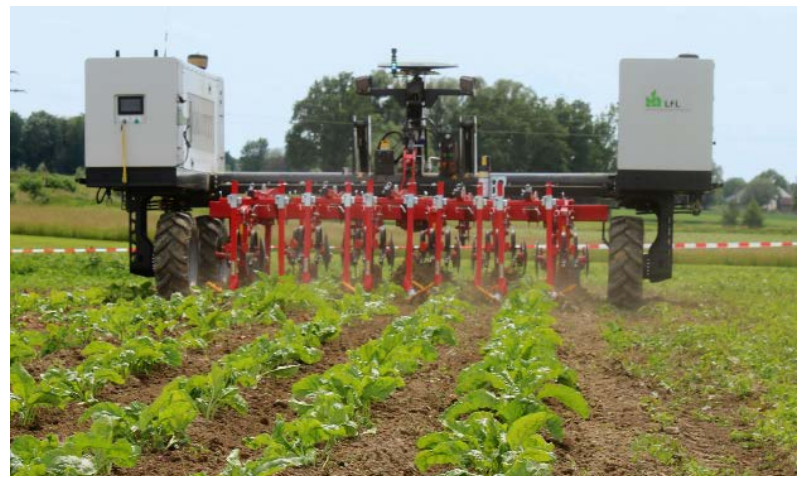
Robotti 150D: Der autonome Multi-Werkzeugträger mit 150 PS kommt beim Eggen, Säen, zur mechanischen Bestandespflege oder für Pflanzenschutzmaßnahmen zum Einsatz. Dank 92 cm Durchgang kann der Roboter auch in stehenden Beständen arbeiten. Die Flächenleistung wird mit bis zu 3 ha je Stunde angegeben.
