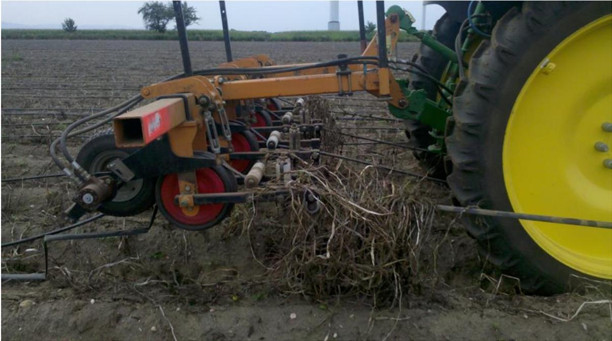
Abbildung 2: Heben der Tropfschläuche aus einem Kartoffelbestand
