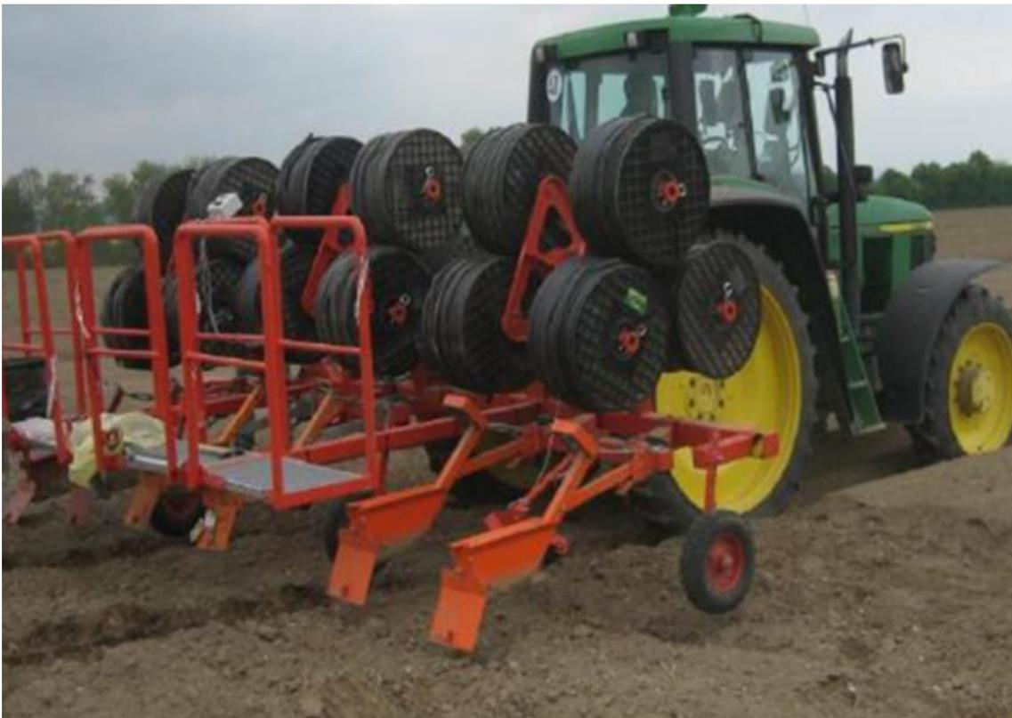
Abbildung 1: Eigenkonstruktion einer Verlegemaschine der Agrar-Genossenschaft eG Zodel
