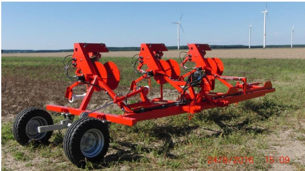
Abbildung 6: Finaler Prototyp des 3-reihigen Bergegerät für Tropfschläuche
