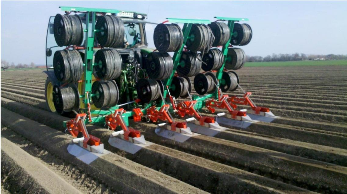
Abbildung 5: 6-reihiges Verlegegerät für Tropfschläuche mit hydraulisch absenkbareren Magazinhaltern
