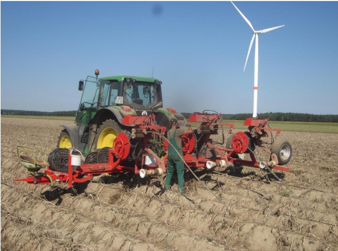
Abbildung 7: Finaler Prototyp des 3-reihigen Bergegerätes mit Mitfahrgelegenheit für eine Bedienperson
