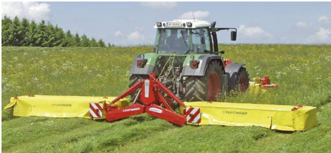
Abb. 5: Leichtzügige Mähkombination Pöttinger NovaDisc 900 mit Seitenaufhängung
