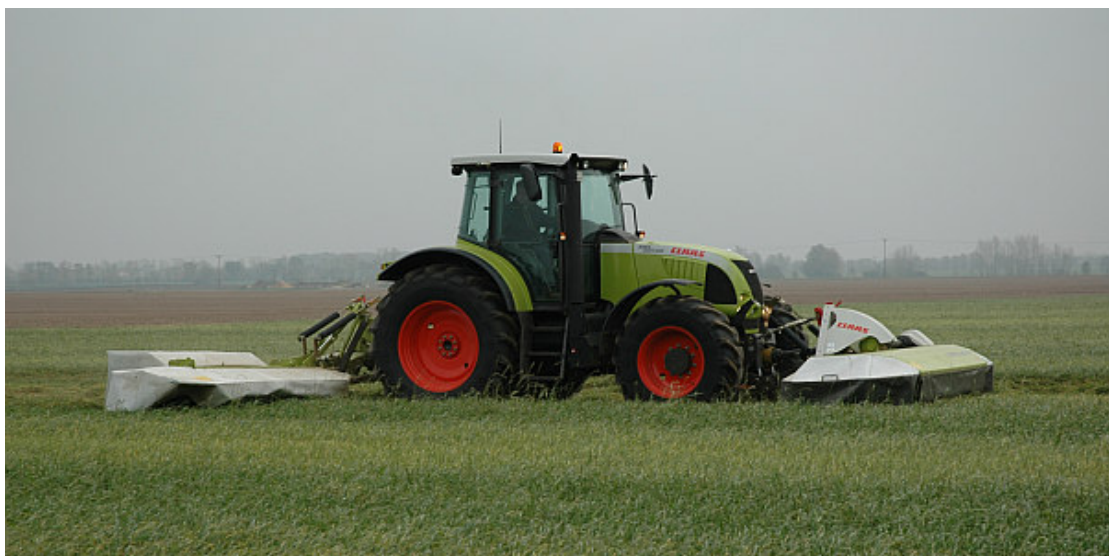
Abb. 2: Front-Heck-Mäherwerkskombination am Traktor in der Dreipunkthydraulik angebaut.
