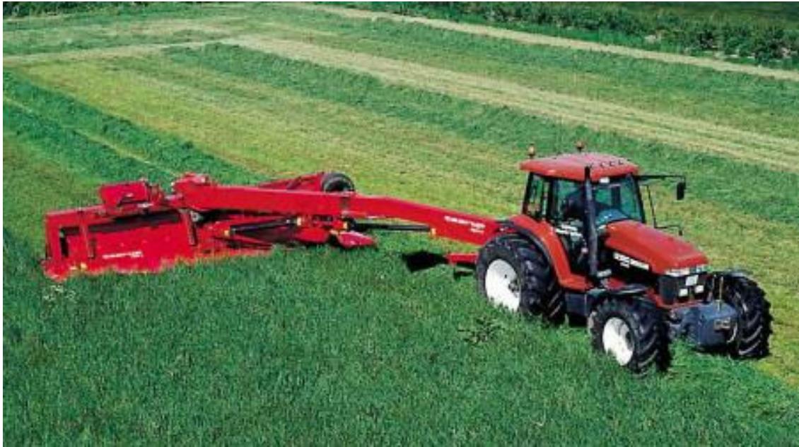
Abb. 15: Schwadzusammenführung bei einem gezogenen Mähwerk mit 6 m Arbeitsbreite (Kverneland 2005).
