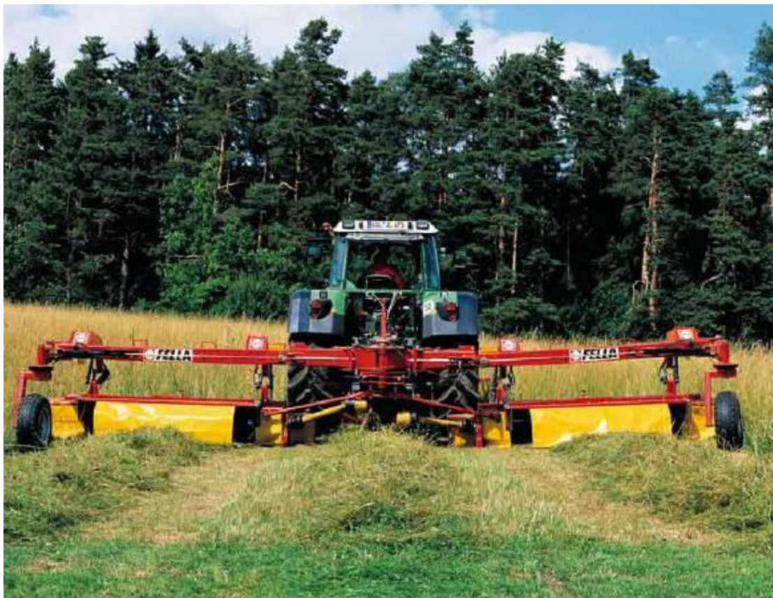
Abb. 14: Fella SM 900 Trans megacut, Dreifachkombination mit Transportfahrwerk im praktischen Einsatz (Fella 2007)
