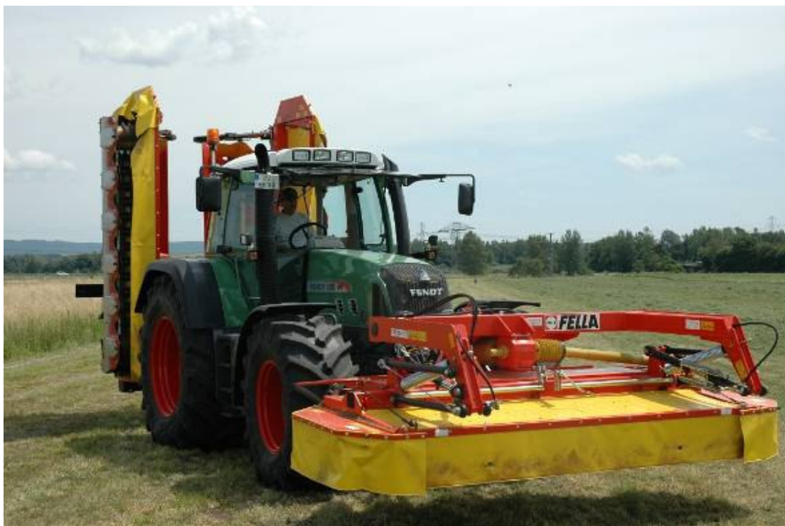
Abb. 13: Fella SM 900 TL KC mit Zinkenrotoraufbereiter in Kombination mit Fella SM 310 FZ KC mit Zinkenrotoraufbereiter (Fella 2007)
