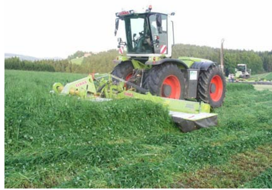
Abb. 16: Links der Versuch einen Feldhäcksler mit einer Triple-Mähwerkskombination zusätzlich auszulasten. Rechts der Systemtraktor mit einer Triple-Mähwerkskombination.
