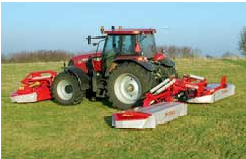
Abb. 10: Triple-Mähwerkskombination in aufgelöster Form (JF-Stoll 2007)
