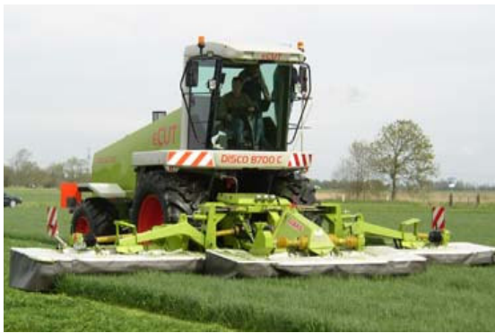
Abb. 17: Großflächenmäher auf der Basis umgebauter Feldhäcksler von Claas.
