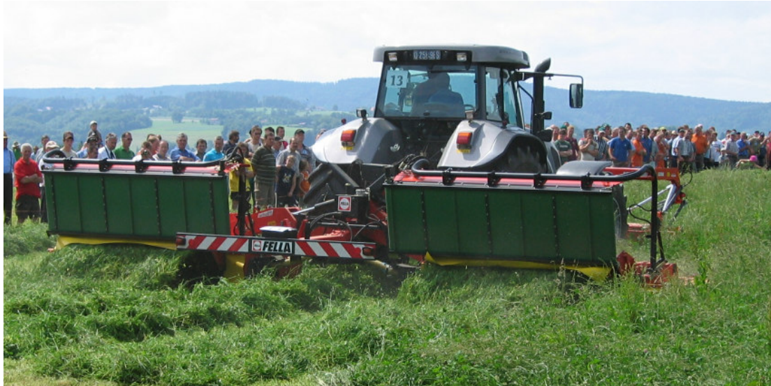
Abb. 4: Das Schmetterlingsmähwerk mit ausgeschwenkten Schwadzusammenführungsbändern.
