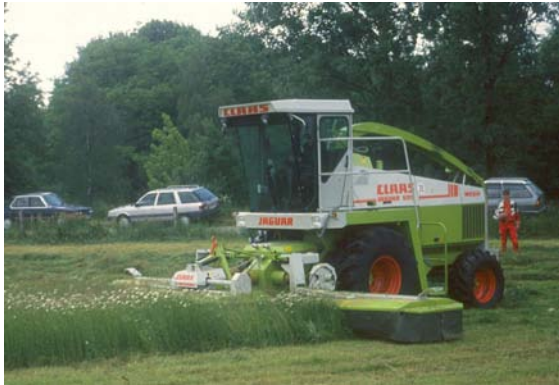
Abb. 16: Links der Versuch einen Feldhäcksler mit einer Triple-Mähwerkskombination zusätzlich auszulasten. Rechts der Systemtraktor mit einer Triple-Mähwerkskombination.
