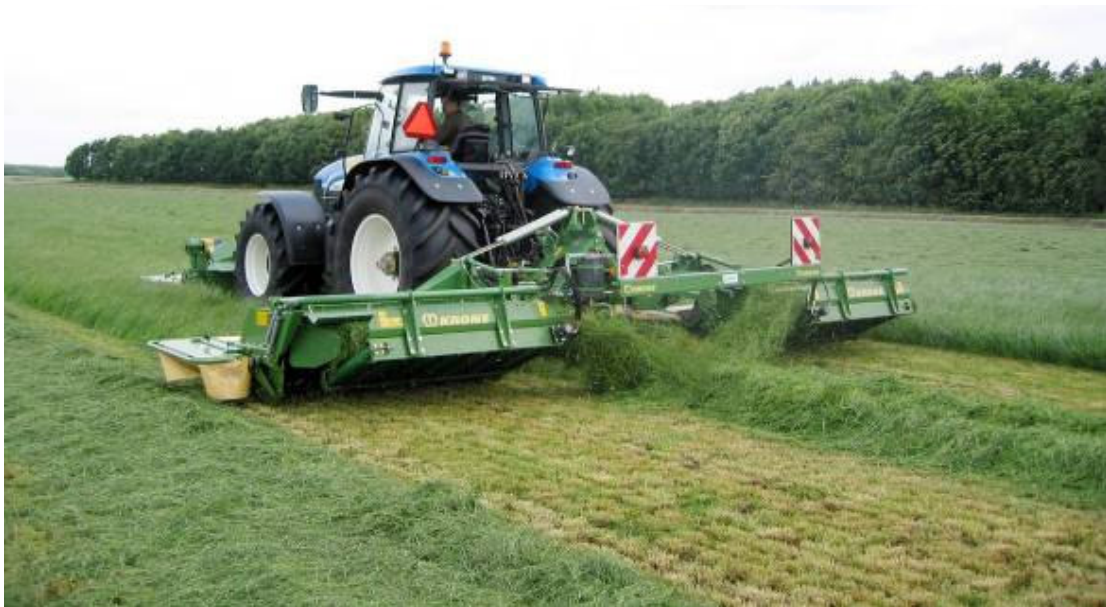
Abb. 8: Krone EasyCut CV mit Schwadzusammenführung im praktischen Einsatz (Krone 2007)
