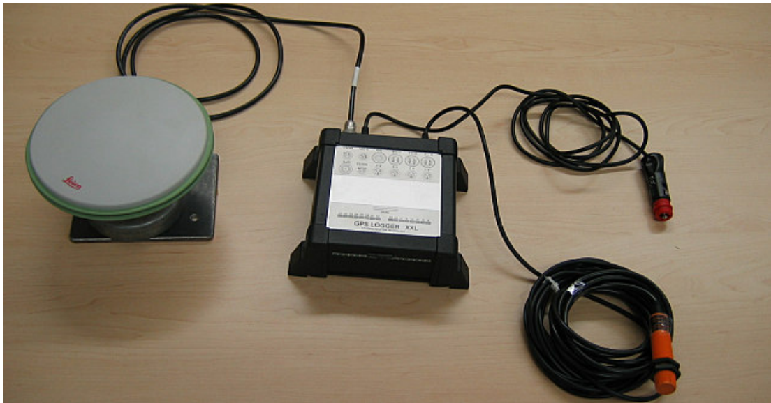
Abb. 20: GPS-Datenlogger mit Antenne, Reedkontakt und Stromversorgung
