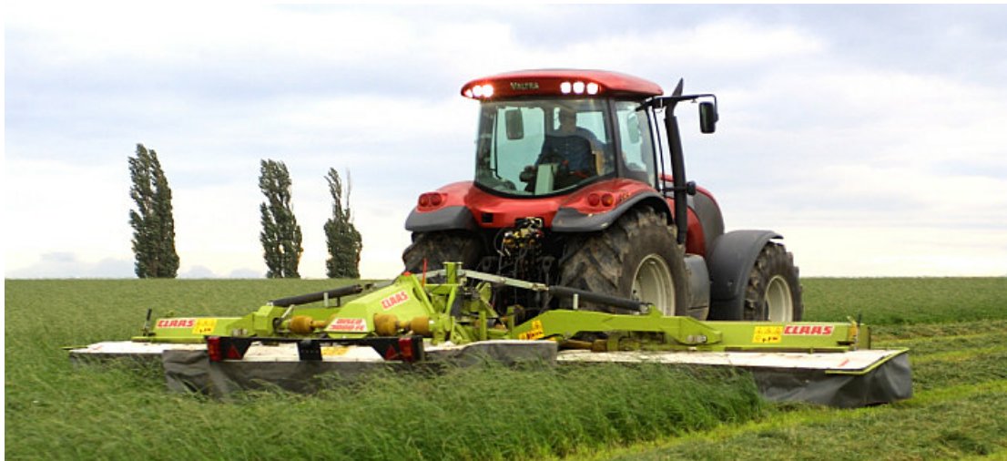
Abb. 3: Traktor mit Rückfahreinrichtung zum Mähen mit einer Triple-Mähkombination in Schubfahrt (Valtra 2003)
