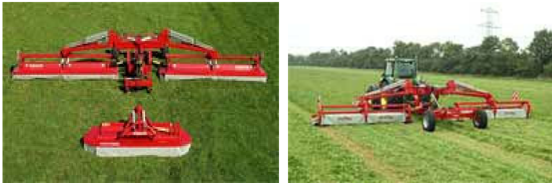
Abb. 11: Triple-Mähkombination mit eigenem Fahrwerk (Stoll 2007)
