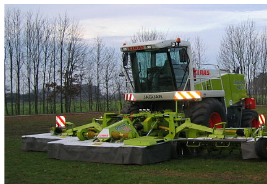
Abb. 17: Großflächenmäher auf der Basis umgebauter Feldhäcksler von Claas.
