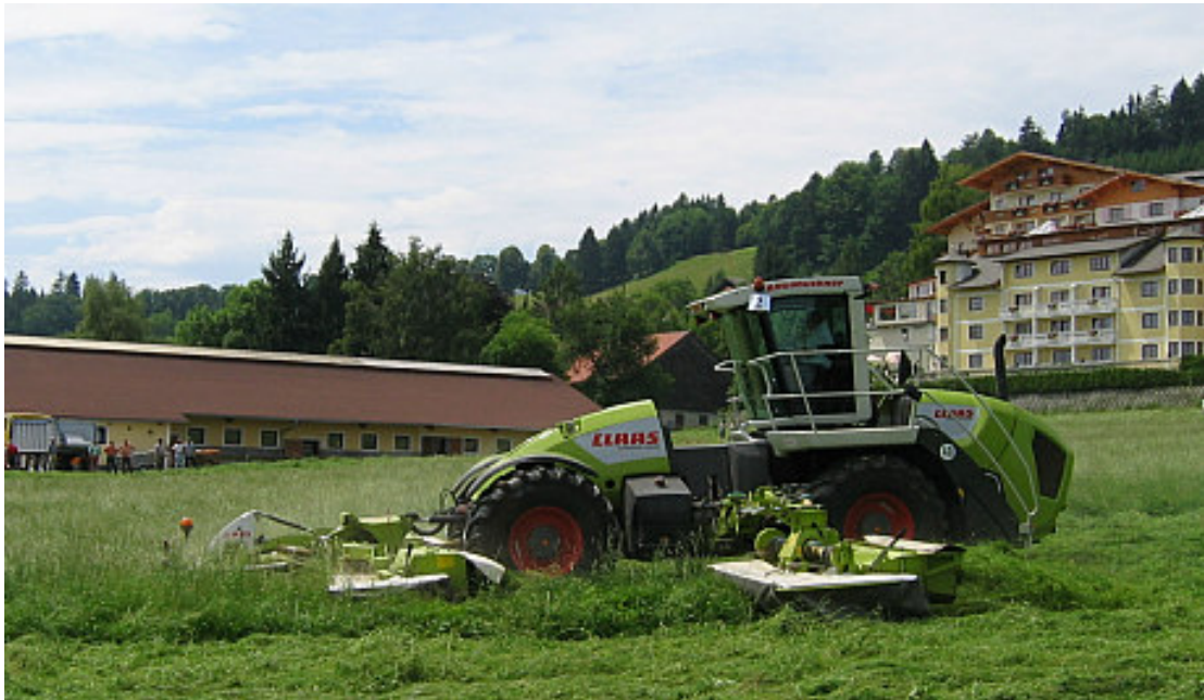
Abb. 19: Selbstfahrmäher mit Triple-Mähkombination im Frontanbau und zwei Mähbalken an seitlichen Auslegern. Zum Transport wird die Kabine gedreht.
