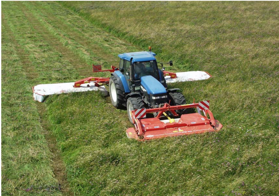
Abb. 9: Kuhn GMD 883, mit LIFT-CONTROL, der Non-Stop-Anfahrtsicherung (Kuhn 2007)
