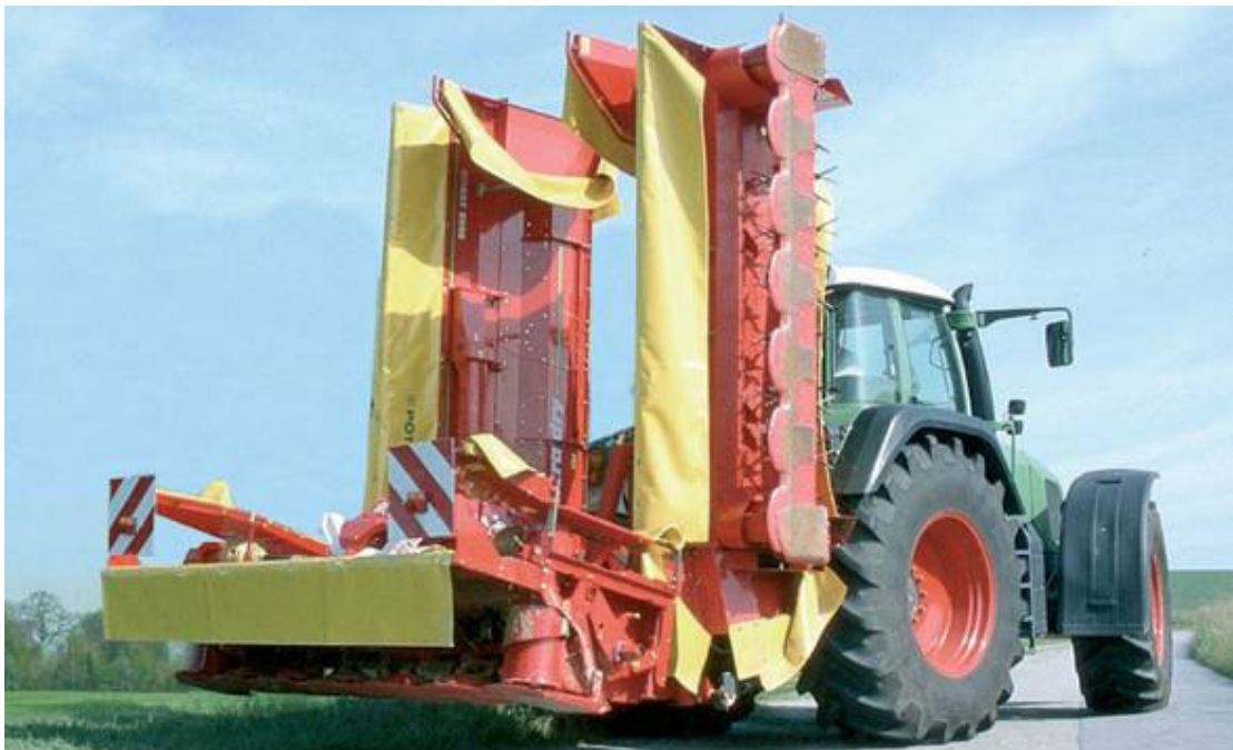
Abb. 7: Pöttinger NovaCat 8600 extradry in der Transportstellung, hier die Schubfahrtvariante für Traktoren mit Rückfahreinrichtung (Pöttinger 2006)
