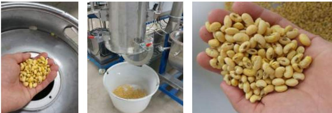
*Nach dem Weichen über 24 Stunden (links) wurden die Sojabohnen in einen Trocknungssimulator gedarrt (Mitte) und das fertige Produkt (rechts) im Labor analysiert.*
