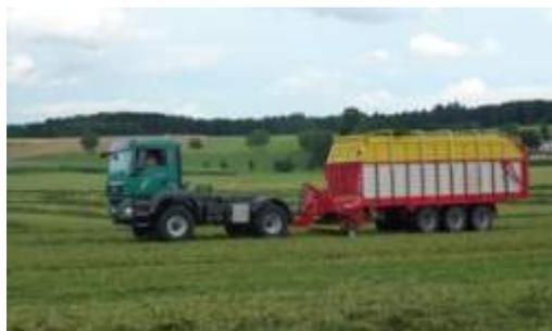
*Einsatz des Mähaufbereiters mit Schwadfunktion (links) und des Ladewagens bei der Rotkleeernte von Anwelkgut für die Heißlufttrocknung und anschließende Separierung der Blattmasse und Stängel (rechts)*
