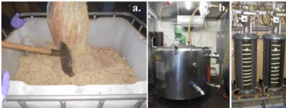
*Zuckerrübenbrei bei der Silierung (links), Adaptation der Fermenterbiologie an die Zuckerrübensilage (Mitte), Einstufige Durchflussfermenter (rechts)*
