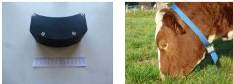
*Der dritte Gehäuseprototyp des GPS-GSM Ortungssystems der Firma Blaupunkt Telematics im Detail (links) und im Einsatz für Forschungszwecke (rechts)*
