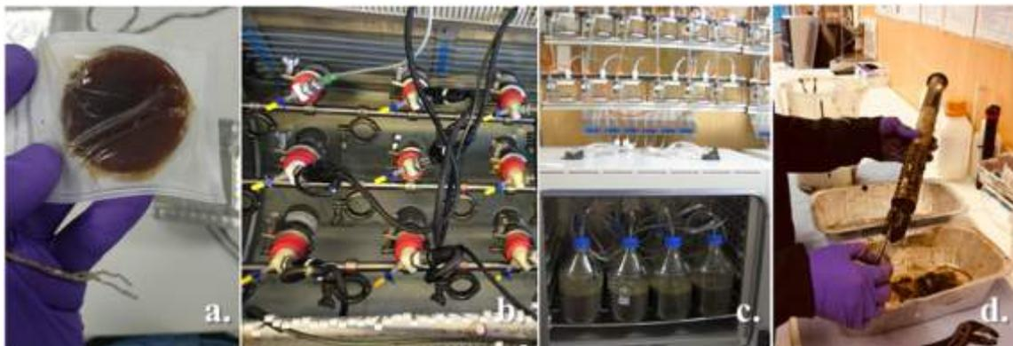
*Siloabdeckungsprobe (links), ATS-Anlage (Mitte links), Batch-System (Mitte rechts), Expositionshalterung im Durchflussversuch (rechts)*
