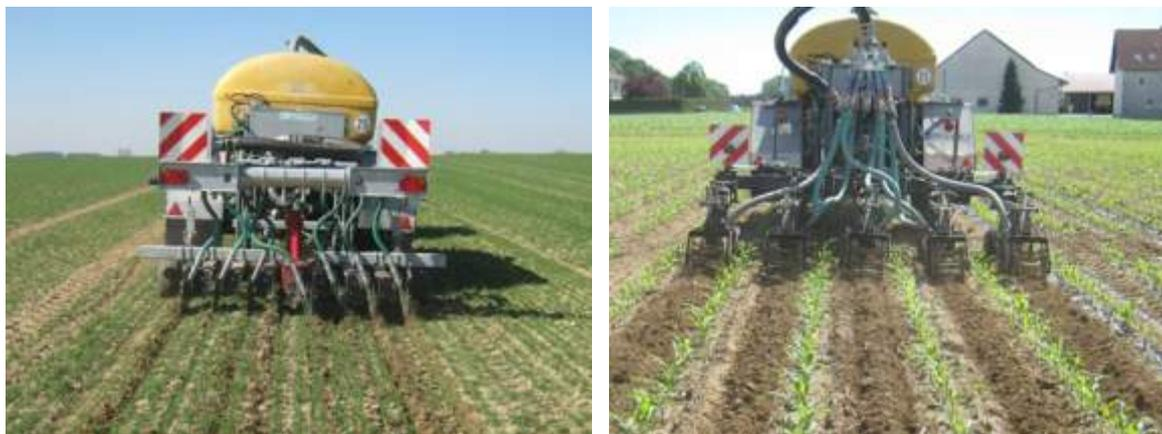
*Versuchsgüllefass mit tiefer Scheibentechnik im WW (links) und mit 5 - reihigem Strip – Till – Gerät zur Gärrestausbringung in den Maisbestand (rechts)*
