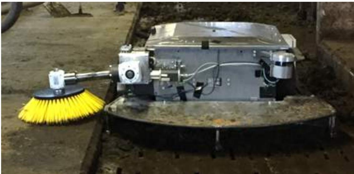
*Versuchsträger bei der Liegeboxenreinigung*
