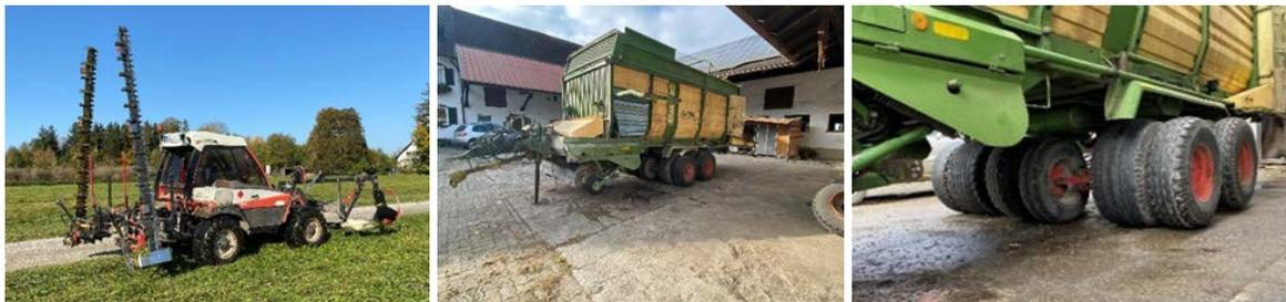
*Mähtrakt mit Doppelmessermähwerk zum Mähen (links) und angepasster Ladewagen zum Bergen des Materials auf vernässten Moor-/Anmoorflächen (Mitte und rechts)*
