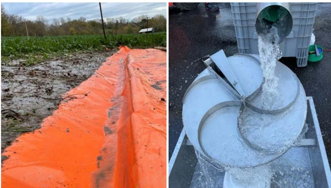
*Erosions-Wasser-Auffangvorrichtung im Praxisversuch (links), Coshoc-ton-Rad mit Zuleitung im Praxisversuch (rechts)*
