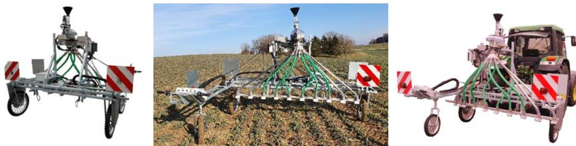
*Versuchsparzellendüngerstreuer: Vorderansicht (links), Einsatz im Feld (Mitte), aufgesattelt zum Transport am Schlepperdreipunkt (rechts)*
