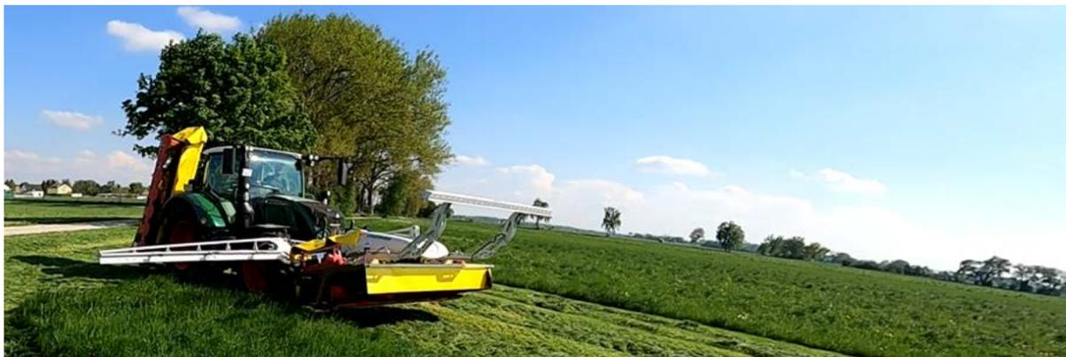
*Mähgespann: Traktor mit Front- und Heckmäherwerk sowie dem Sensorbalken zum System SENSOSAFE für beide Mäherwerke*
