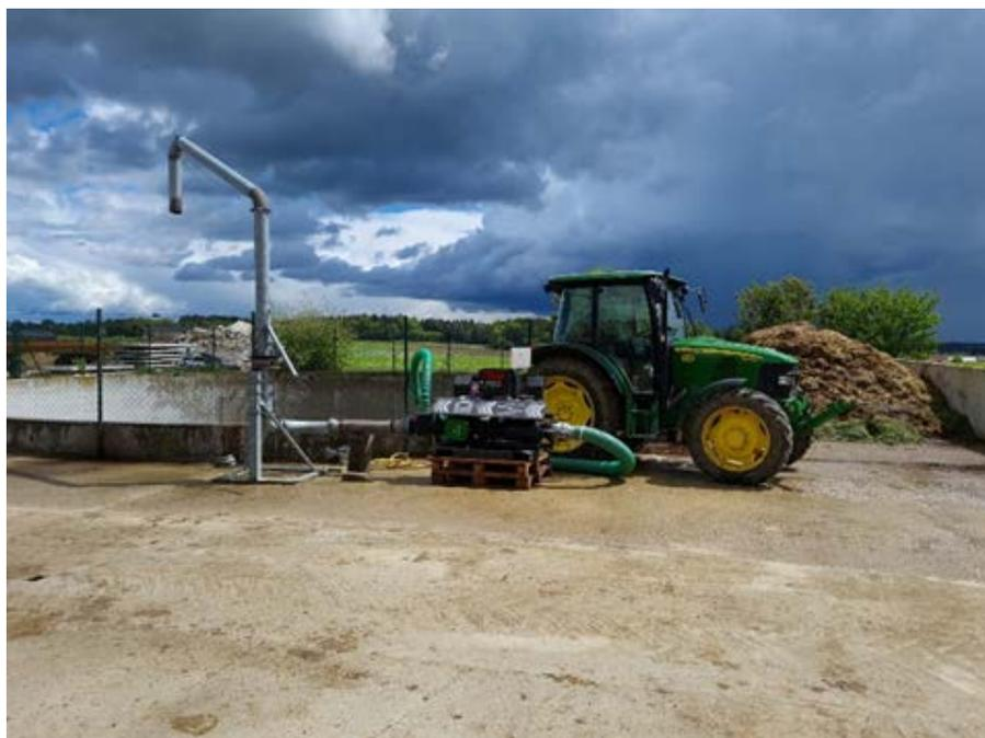
*Mobile NIRS-Station zur Schätzung der Gülleinhaltsstoffe beim Befüllen*
