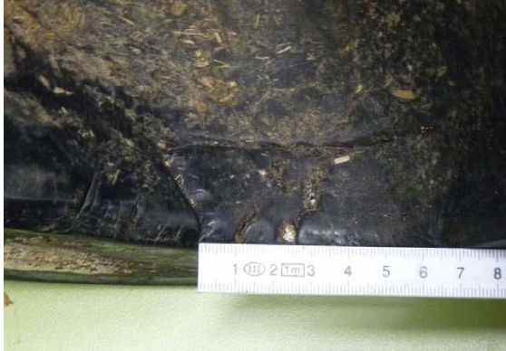
Abbildung 4: Verschleiß am Elastomerkern einer Exzentrerschneckenpumpe.
