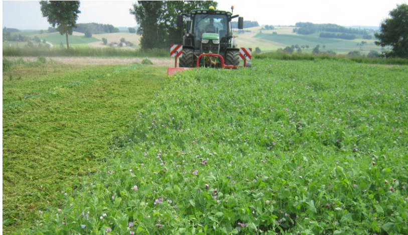
Zerkleinerung ZF → Mulcher Mulchsaat ohne Saatbettbereitung
