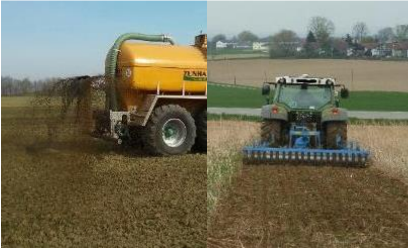
Breitverteiler → Kreiselegge: Mulchsaat mit Saatbettbereitung
