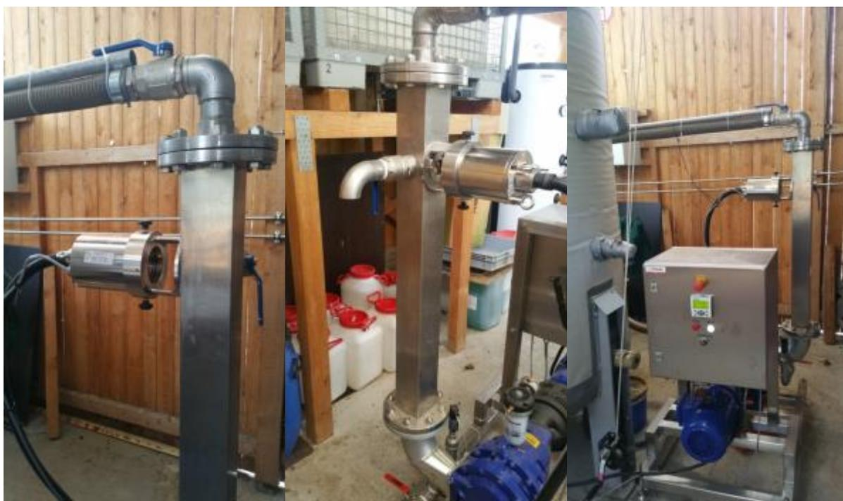
Abb. 2: Eingebauter NIR-Sensor in einem Loop
