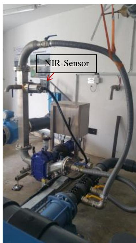
Abb. 12: Pumpkreis in einer Schlauchverrohrung (Loop) mit Drehkolbenpumpe und NIR-Sensor
