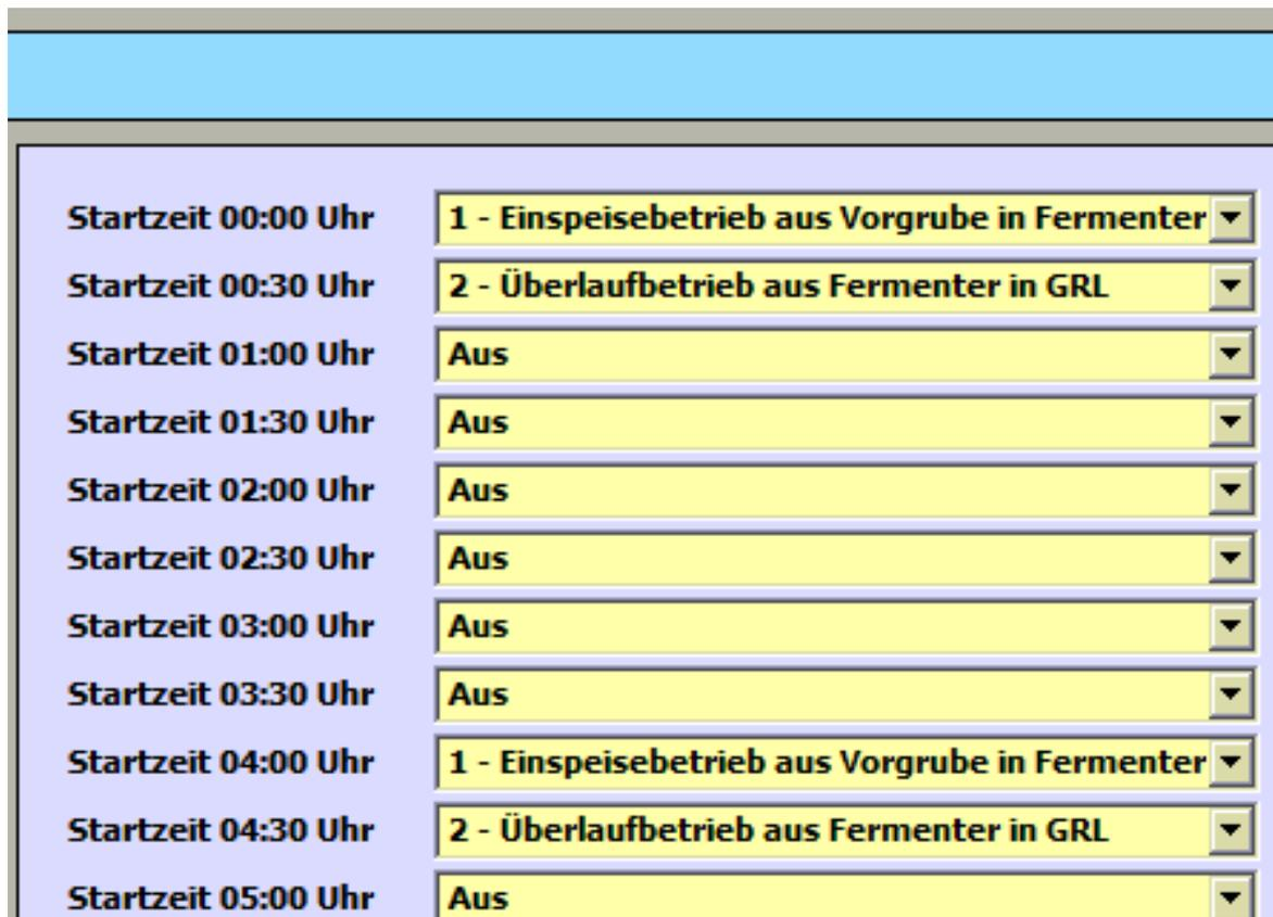
Abb. 15: Pumpzyklen (Schalt- und Laufzeiten) der Biogasanlage Grub (Zoom aus Abb. 14)
