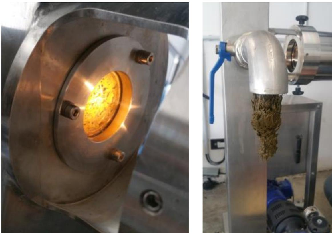
*Abb. 20: Verdichtetes Substrat im Messfenster vor dem NIR-Sensor (links), mit Ablassen des Substrates über den Probenahmehahn vor dem NIR-Sensor (rechts)*
