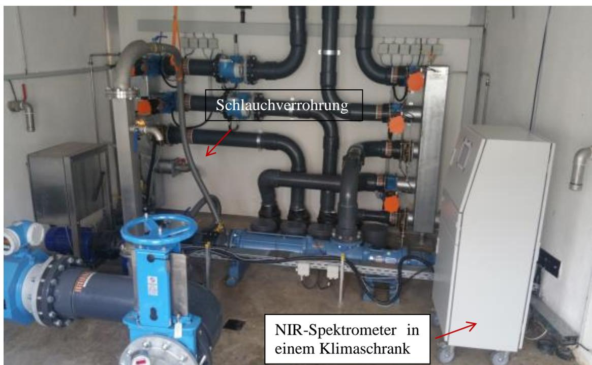
Abb. 13: Kompletter Versuchsaufbau mit Klimaschrank (Spektrometer, PC), Drehkolbenpumpe, NIR-Sensor und Pumpkreis (Loop)
