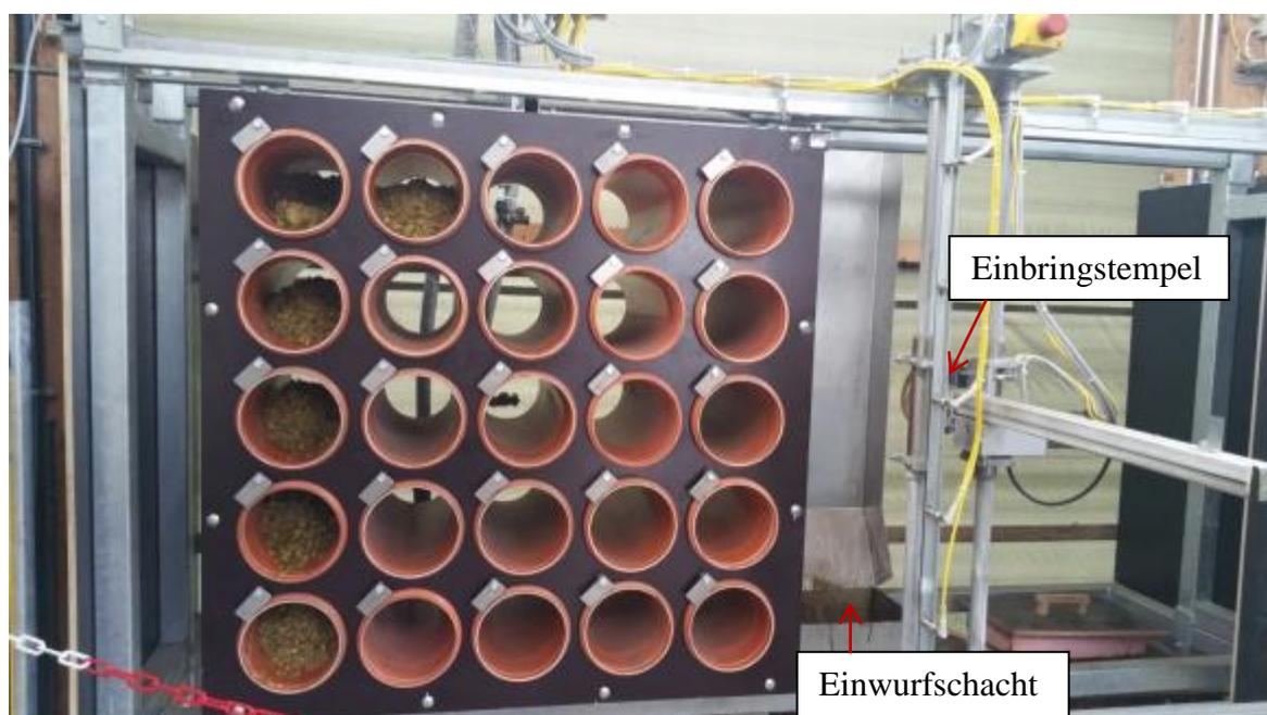
Abb. 5: Automatisches Fütterungssystem (25 Zylinder) mit Einbringstempel und Einwurfschacht
