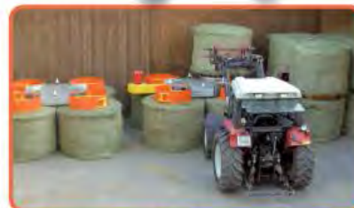
3 Belüftungsmodul für 24 Rundballen
