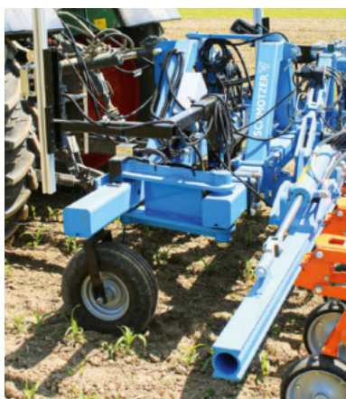
Der Kombi-Parallelogramm-Verschieberahmen AV5 von Schmotzer besitzt einen sehr hohen Verschiebeweg. Auch die Fingerhacke mit zwei möglichen Arbeitswinkeln hat ein unabhängiges Sternparallelogramm.
