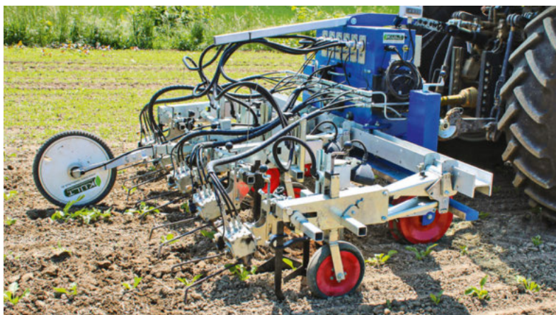
Hacken in der Reihe ist schon praxisreif: Beim Robovator kann das Kamerasystem zwischen Kultur- und Unkrautpflanze unterscheiden und so wird zwischen den einzelnen Rübenpflanzen automatisch gehackt.
