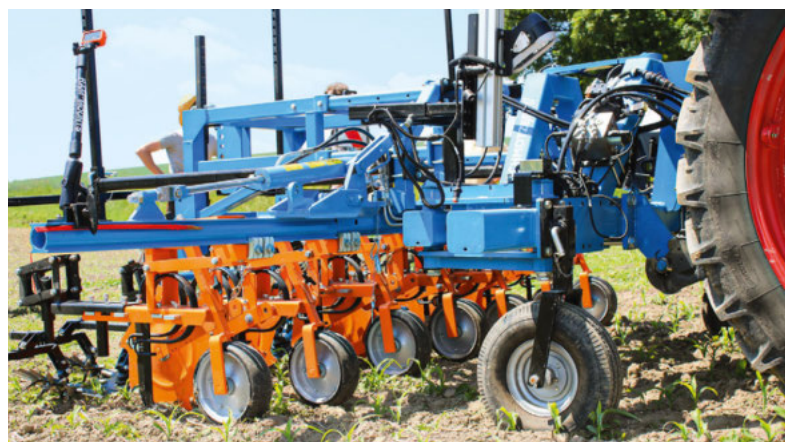
Der Kombi-Parallelogramm-Verschieberahmen AV5 von Schmotzer besitzt einen sehr hohen Verschiebeweg. Auch die Fingerhacke mit zwei möglichen Arbeitswinkeln hat ein unabhängiges Sternparallelogramm.
