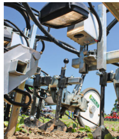
Hacken in der Reihe ist schon praxisreif: Beim Robovator kann das Kamerasystem zwischen Kultur- und Unkrautpflanze unterscheiden und so wird zwischen den einzelnen Rübenpflanzen automatisch gehackt.
