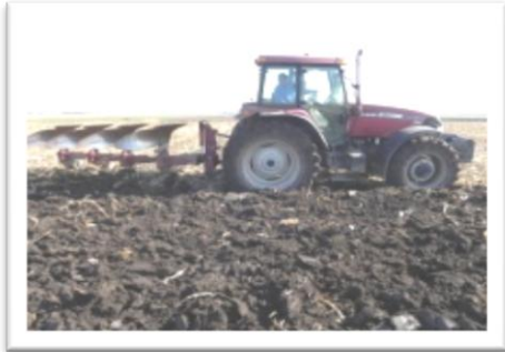
Bodenbearbeitung mit 4-Schar Wendepflug (25 cm Arbeitstiefe)
