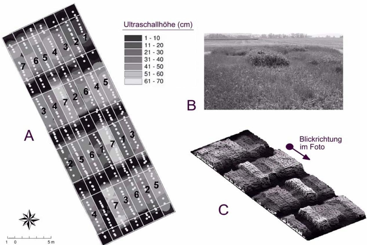
**Abb. 1** Interpolierte Karte (A) der Ultraschallhöhen aus der mobilen Anwendung ergänzt durch eine 3D-Ansicht (C) und ein Foto (B) des überfahrenen Parzellenversuches. Die Punkte in Karte A kennzeichnen die GPS-Positionen an denen Ultraschallhöhen aufgezeichnet wurden.
