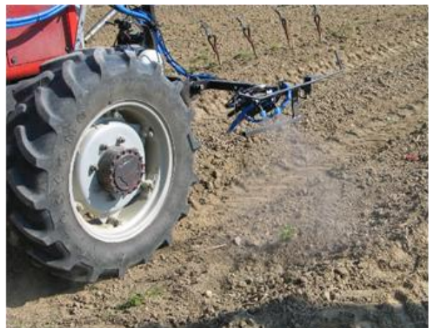
Sensorgesteuerte Flachstrahldüsen zur Reihenbehandlung
