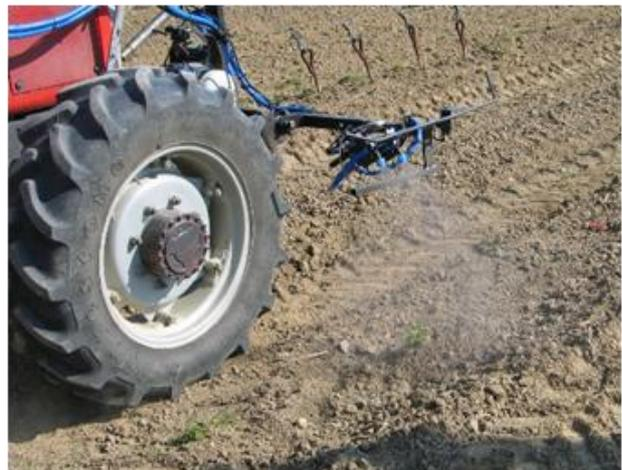
*Sensorgesteuerte Flachstrahldüsen zur Reihenbehandlung*
