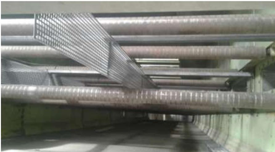
Abb. 5.3: Trocknungsband mit eingebauten Diffusorblechen und Lufteinlässen auf der rechten Seite
