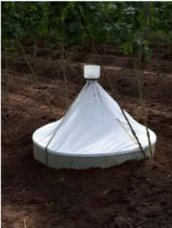
*Abb. 7.4: Aufbau der Photoektoren zentral in jeder Parzelle des Versuchsgartens.*
