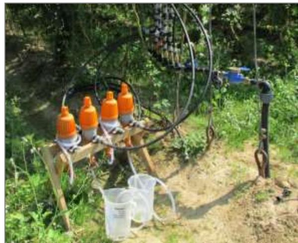
*Abb. 1.6: Düngereinspeisevorrichtung zur Fertigation von Hopfen*
