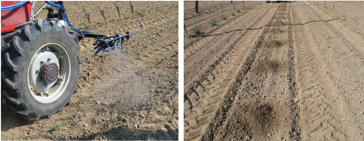
Abb. 5.23 und Abb. 5.24: Sensorgesteuerte Applikationstechnik zum 1. Anwendungszeitpunkt (19.04.2011) bis 40 cm Wuchshöhe
