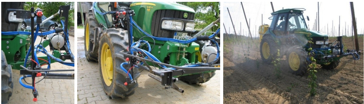
Abb. 5.25, Abb. 5.26 und Abb. 5.27: Sensorgesteuerte Applikationstechnik zum 2. Anwendungszeitpunkt (02.05.2011) bis 1,5 m Wuchshöhe
